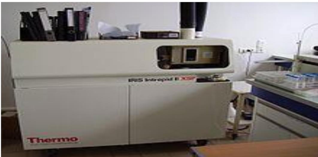
**Figure III. 10.** Un spectromètre ICP-AES.
