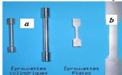
Figure 3.10 Epreuves de traction d'un (a) matériau métallique, (b) matériau polymère ou composite
