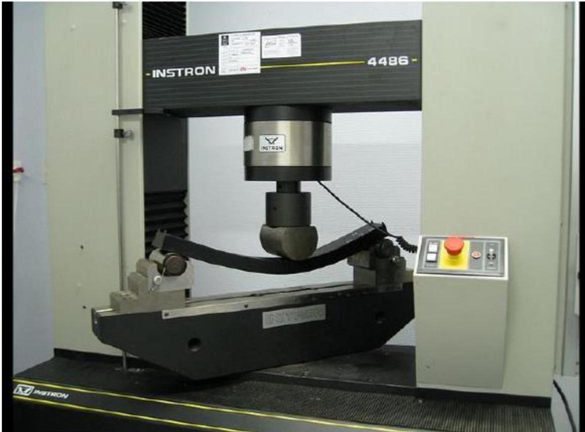
**Figure III. 3.** Poutre en composite sur une machine de traction pour un test de flexion trois points.
