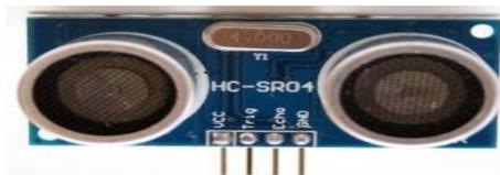
Fig III.10: Capteur Ultrasonic HC-SR04
