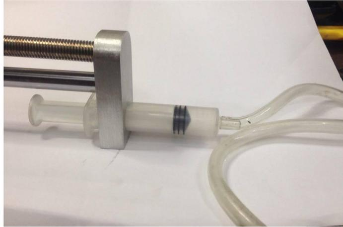
Figure (IV.10) : La seringue avec le système mécanique
