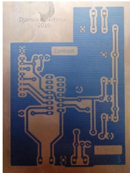
**Figure (IV. 5) :** Carte de la commande sur le typon
