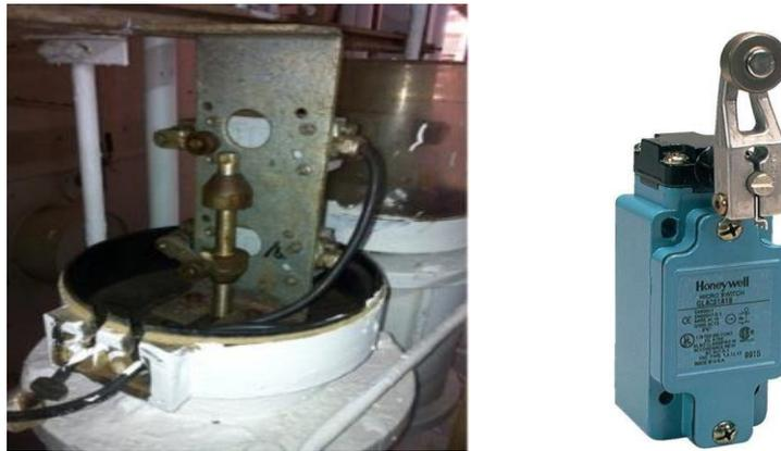
Figure II.8 : Capteur de position (fin de course).
