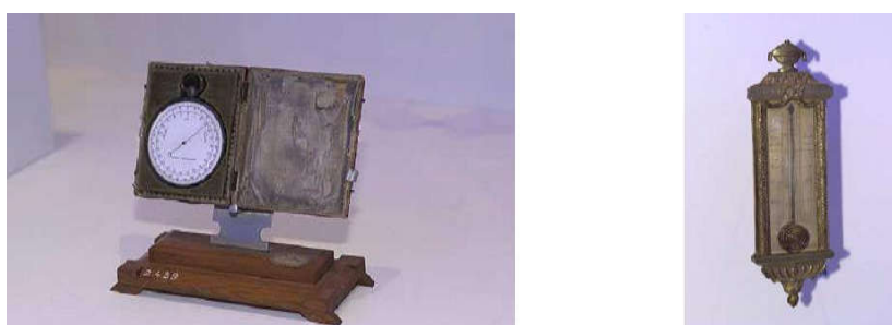
Figure I.1 : Exemples de thermomètre à métal (à gauche) de 1841 et à alcool (à droite) de 1589
