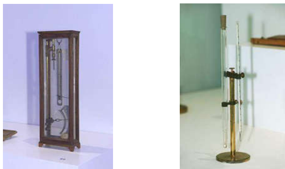
Figure I.4 : Exemples d'hygromètre de Saussure (à gauche) et de psychromètre du 20 ème siècle (à droite)
