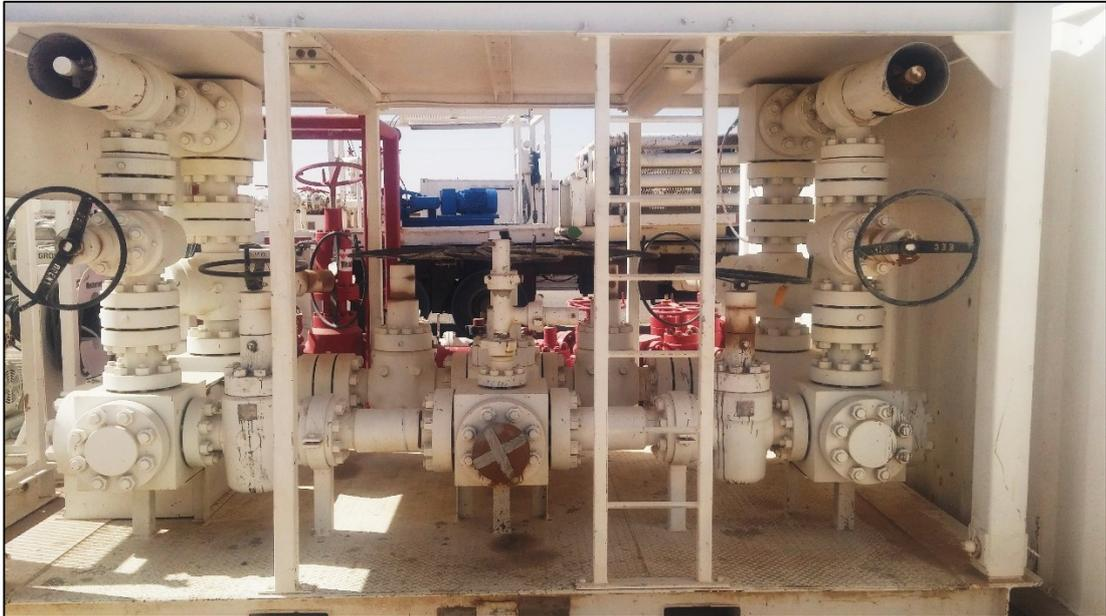
**Figure 4.10 :** MPD choke avec deux semi-automatique choke.
