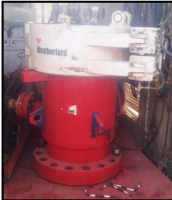
Figure 4.8 : RCD Modelé 7100 utilisé en Algérie.
