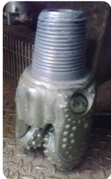
Figure 3 : Etat outil après 12 heures de forage.
