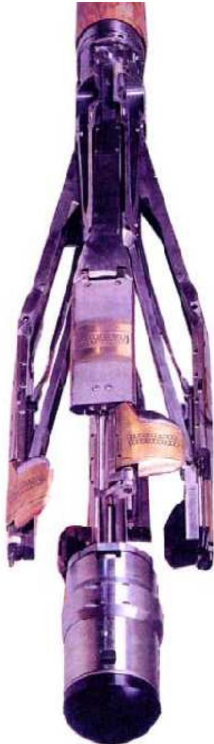
**Fig. II.14:** Caliper centré avec quatre bras. (Image réelle) [5]
