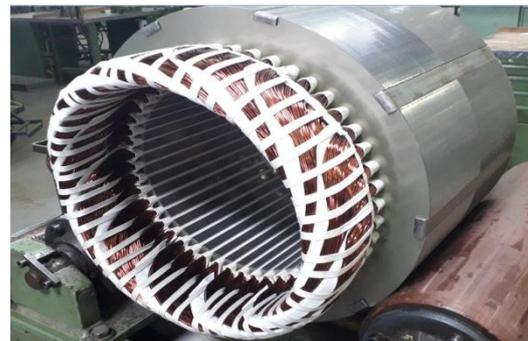
**Figure I.13.** Bobinage du stator
