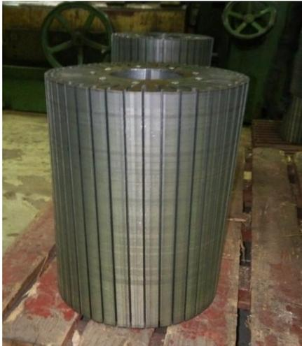
*Figure I.17. Paquet rotorique*
