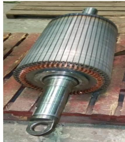
*Figure I.18. Arbre dans le paquet rotorique*
