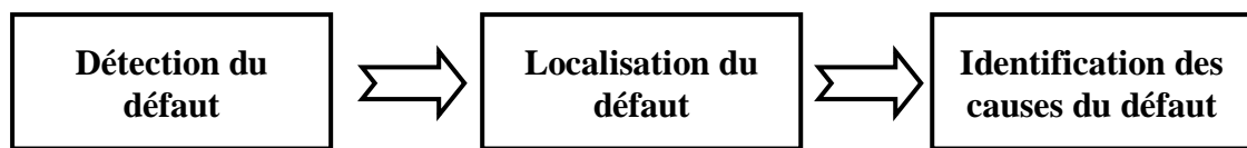
Figure 3.1. Méthodologie de la surveillance des défauts d'un champ PV.
