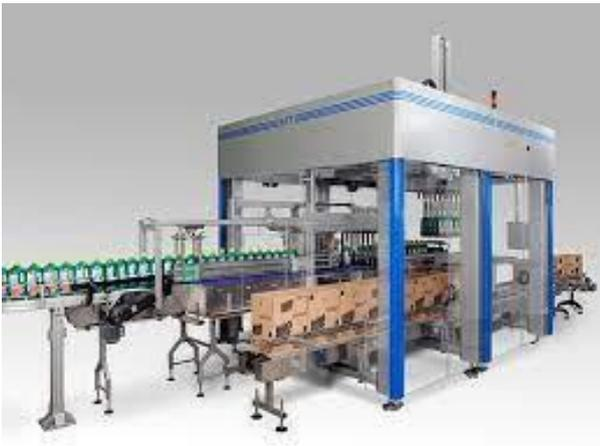
Figure 2.6.2 Encaisseuse de marque ETT
