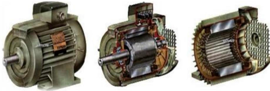
Figure 3.2.3 Moteur asynchrone triphasé
