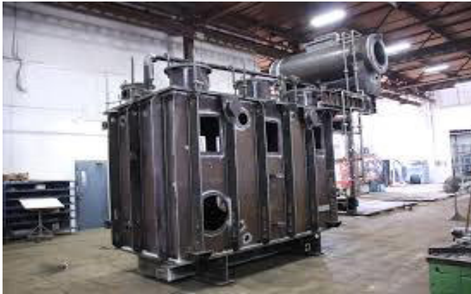
Figure (II-8) : cuve de transformateur
