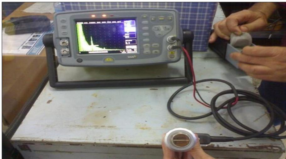
Figure I.8 : Appareil de contrôle ultrason
