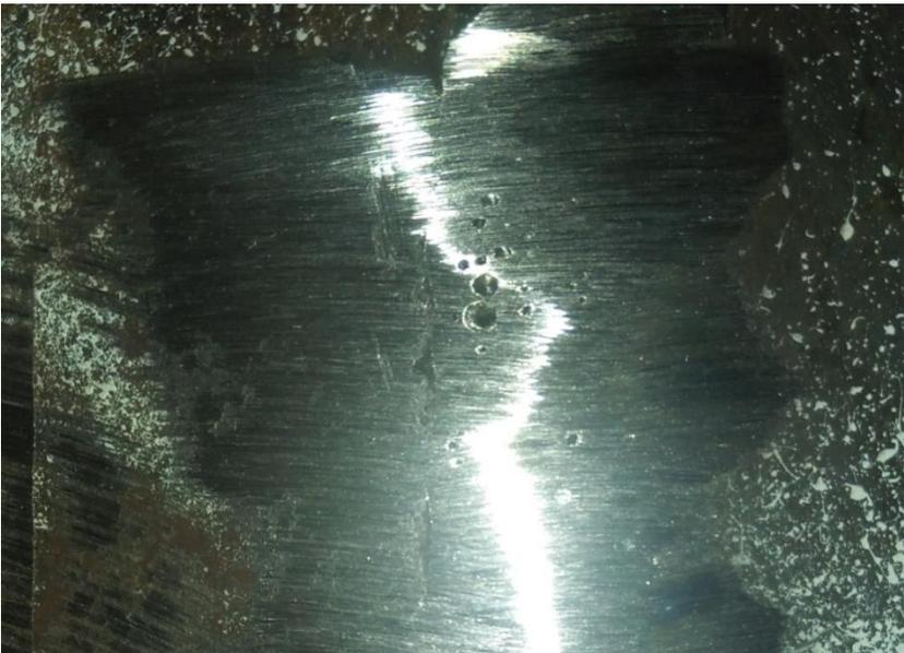
Figure III.25: Défauts des soufflures en réalité
