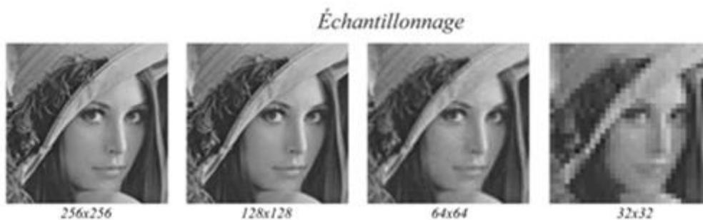
Figure I.7 : Echantillonnage d'une image.
