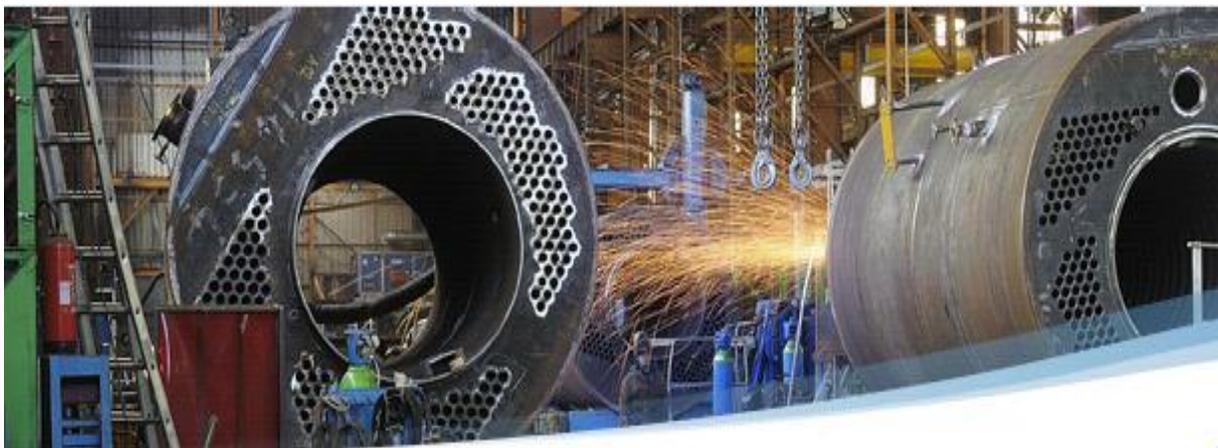
**Figure I.7 :Fabrication de chaudière à vapeur.**
