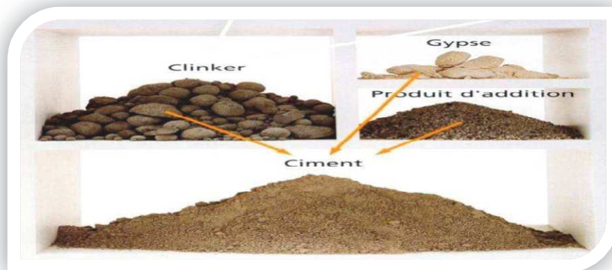
Figure 03 : les principaux composants du ciment.
