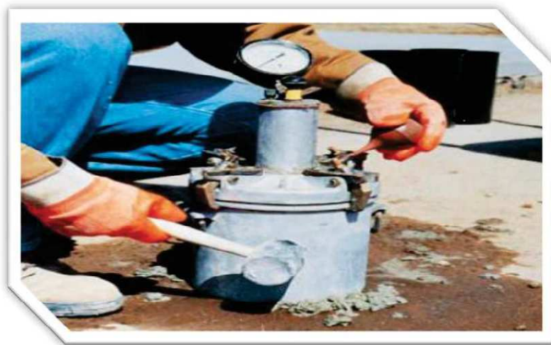
Figure 16: Mesure de la teneur en air occlus à l'aide de l'aéromètre.
