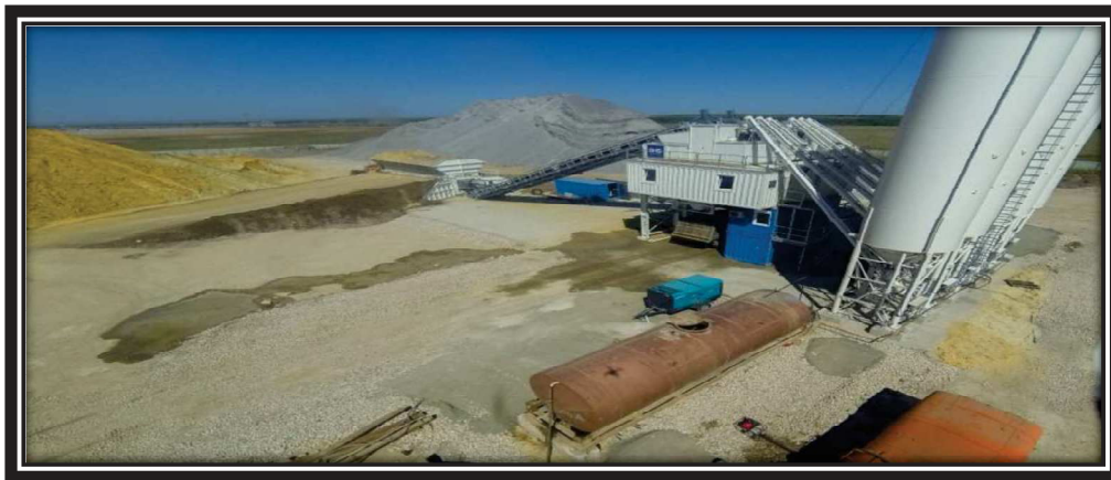
Figure 35: Centrale à béton semi-mobile avec malaxeur à double DKX 4.00 (Russie).
