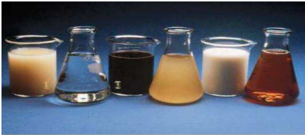
Figure 12 : Adjuvant liquide de gauche à droite : agent anti –lessivage de retrait, réducteur d'eau, agent moussant, inhibiteur de corrosion et agent entraîneur d'air.
