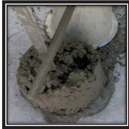
Figure 50 : Affaissement au cône D'ABRAMS.
