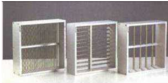
Figure 11: Grilles de mesure le coefficient d'aplatissement.
