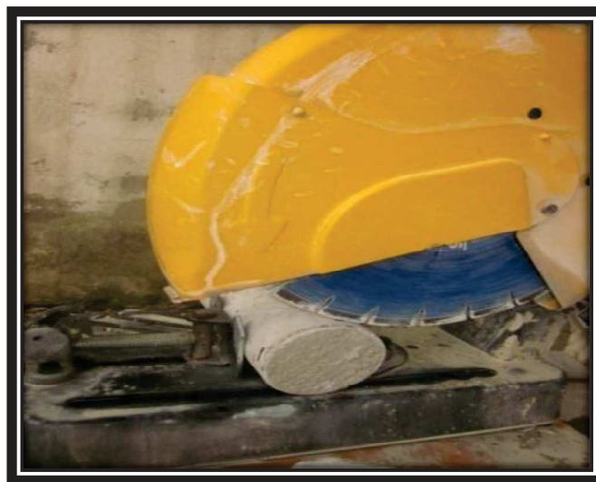
Figure 52: Rectification des carottes.
