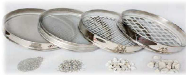
Figure 07: les différents tamis pour l'analyse granulométrique.
