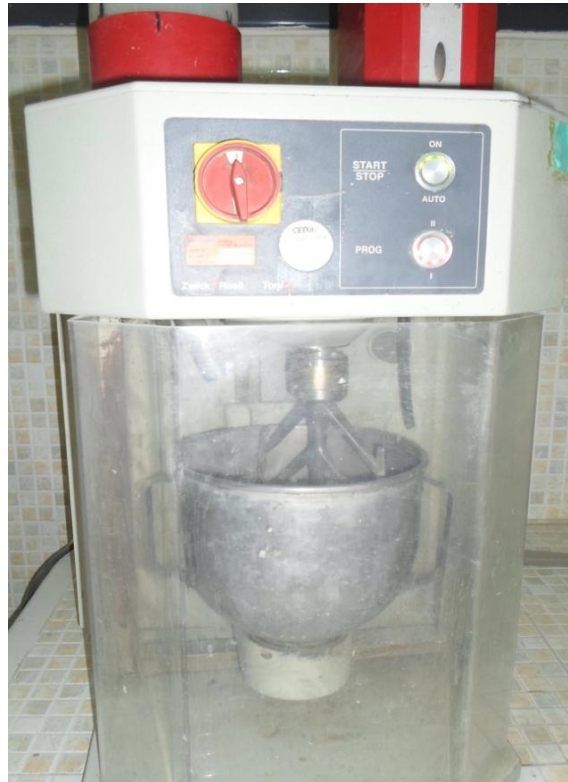
Figure IV.1: Malaxeur pour les mortiers autoplaçants (MAP)
