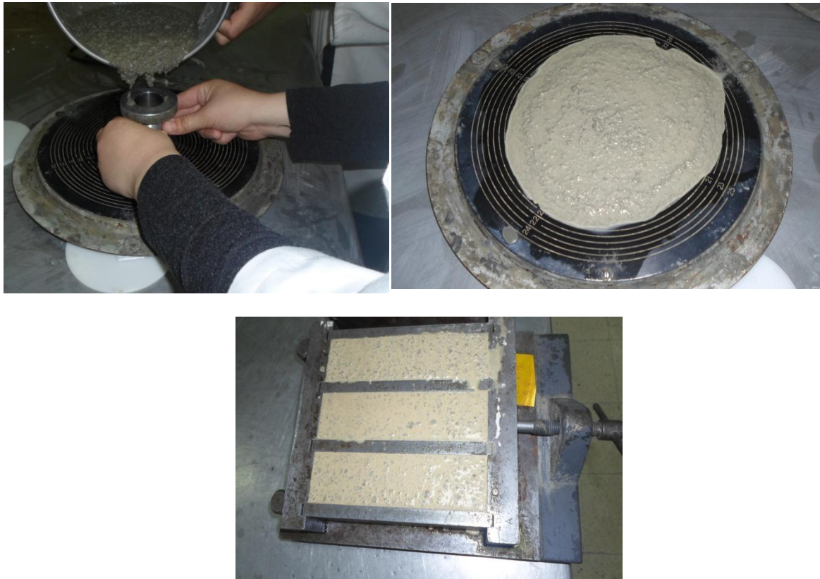
Figure V.1 : L'essai d'étalement sur le mortier autoplaçant frais
