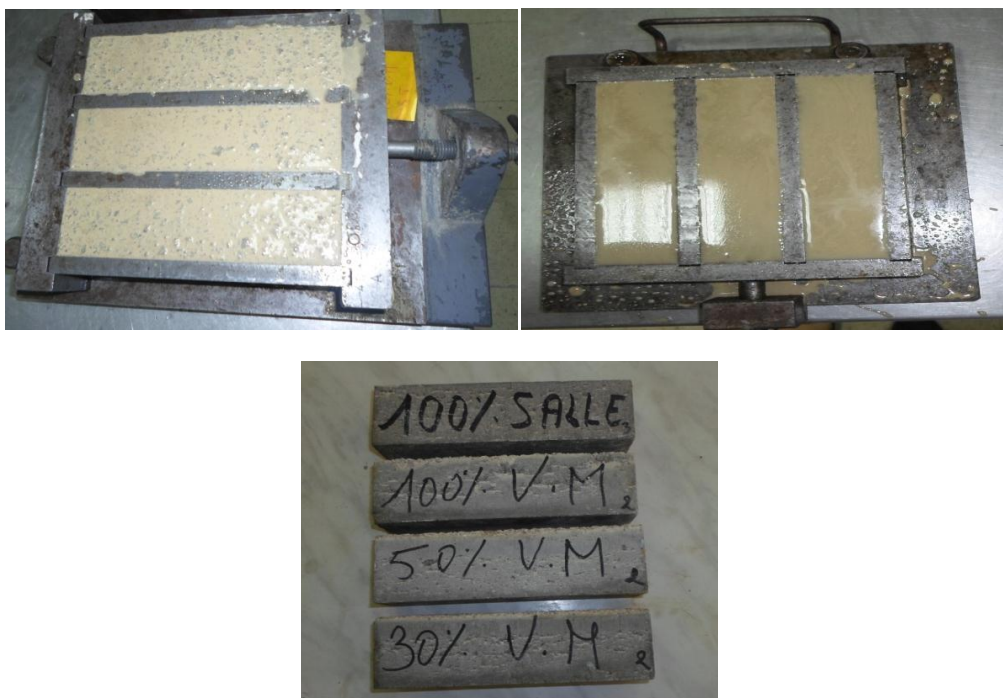
Figure IV.3 : Confection des éprouvettes du mortier autoplaçant
