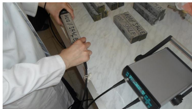
Figure V.7 : L'essai d'ultrason sur le mortier autoplaçants durci
