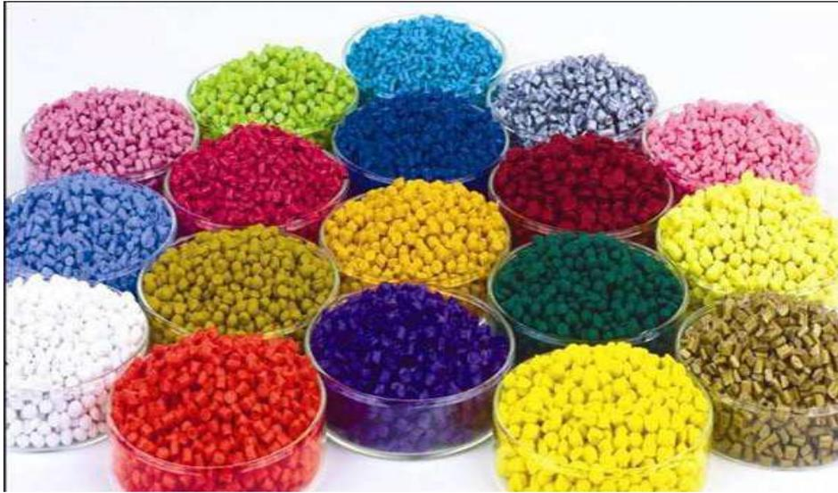
*Fig.II.10.photo de polypropylène recyclé*
