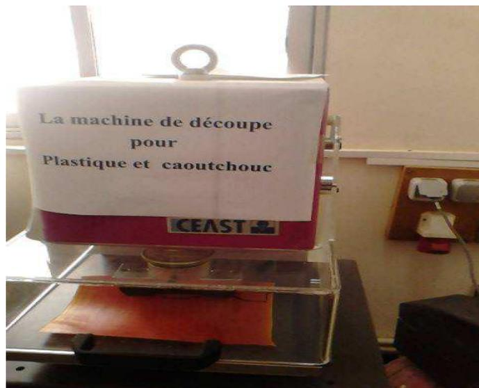
*Fig.IV.7. machine de découpe pour plastique et caoutchouc 'CEAST'*
