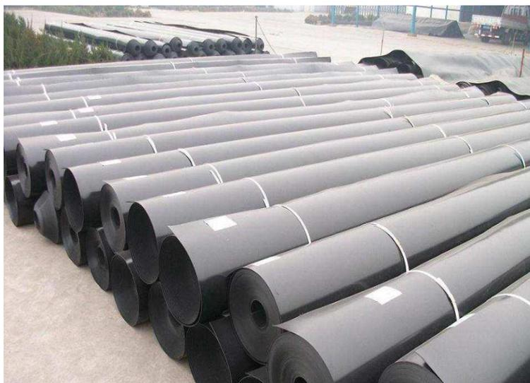
*Fig.I.7. Photo d'un rouleau de géomembranes polymères*
