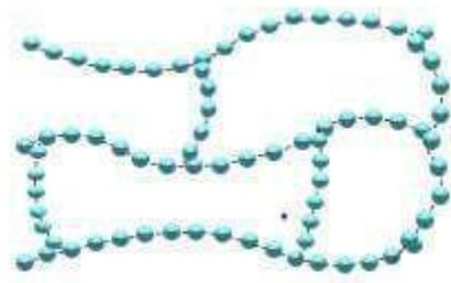
*Fig. II.3. Structure d'un élastomère*
