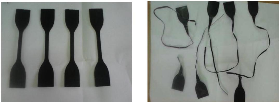
*Fig.V.6. Echantillon 2 [PEHD] (géomembrane réelle)*
