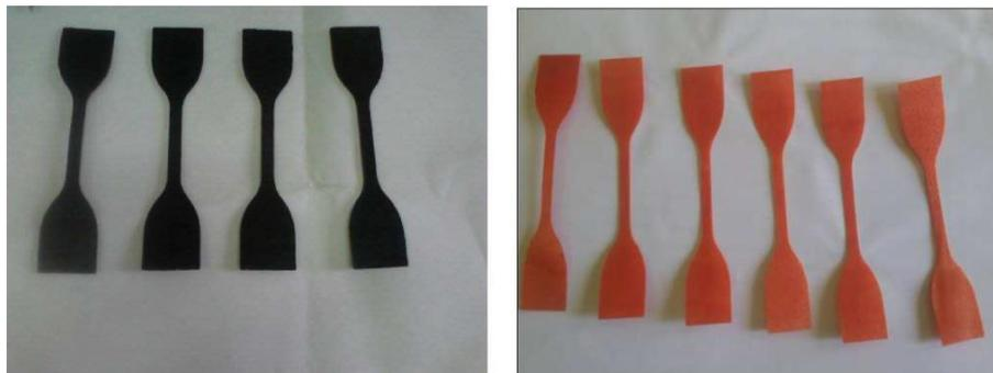
*Fig.IV.9.éprouvettes de traction*
