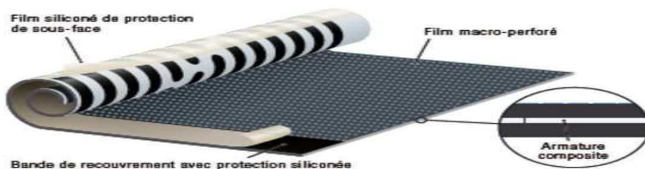
*Fig. I.9. Revêtement d'étanchéité bicouche*
