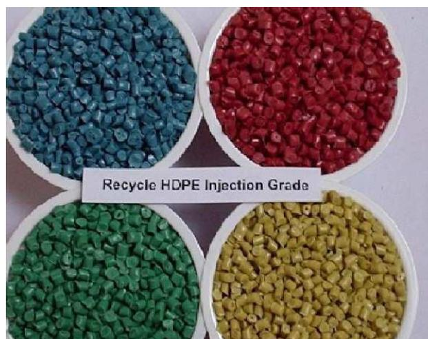
*Fig.II.14. polyéthylène haute densité recyclé*
