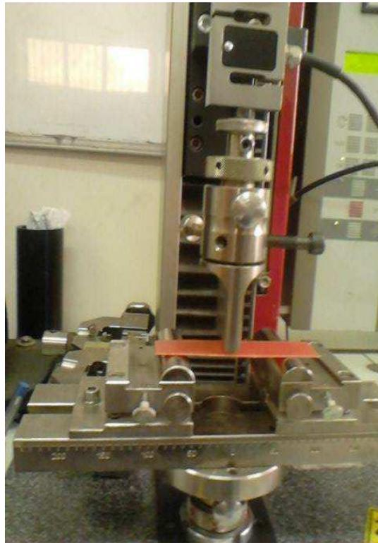
*Fig.V.10.Essai de flexion*
