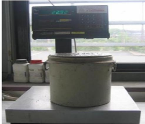
Figure I-11 : Mesure de la masse volumique réelle
