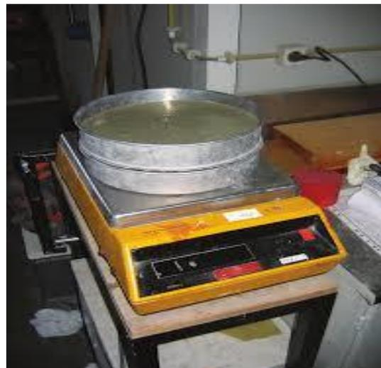
**Figure I-10** : Essai de stabilité au tamis
