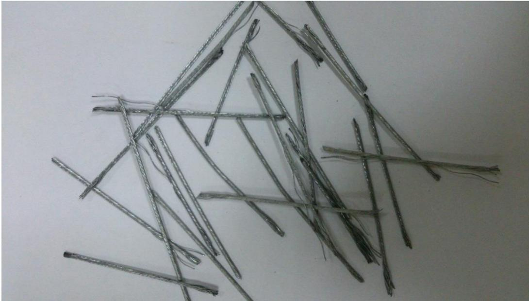
**Figure V-22** : les fibres recyclées
