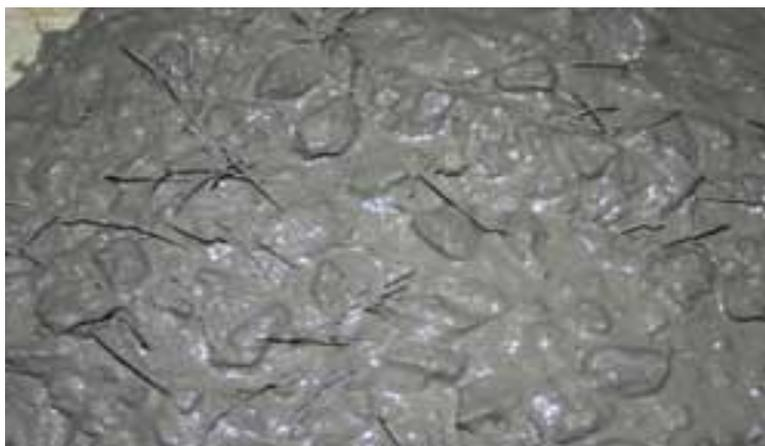
**Figure III-1 : béton autoplaçant fibrée**
