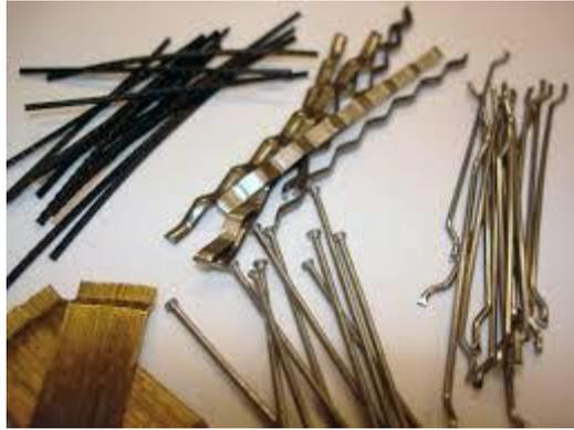
Figure II-1 : les fibres métalliques
