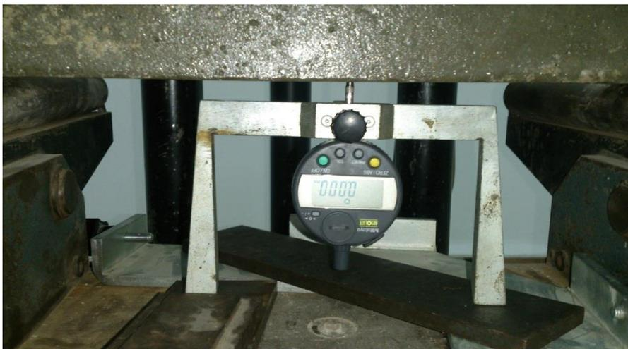
**Figure V-16:** le comparateur(mm 10<sup>-2</sup>)
