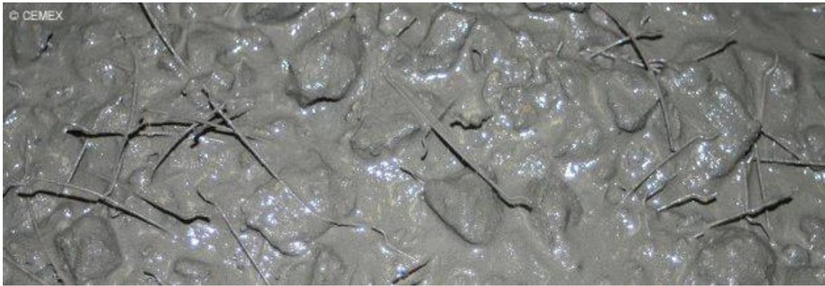
**Figure II-4** : béton fibrée
