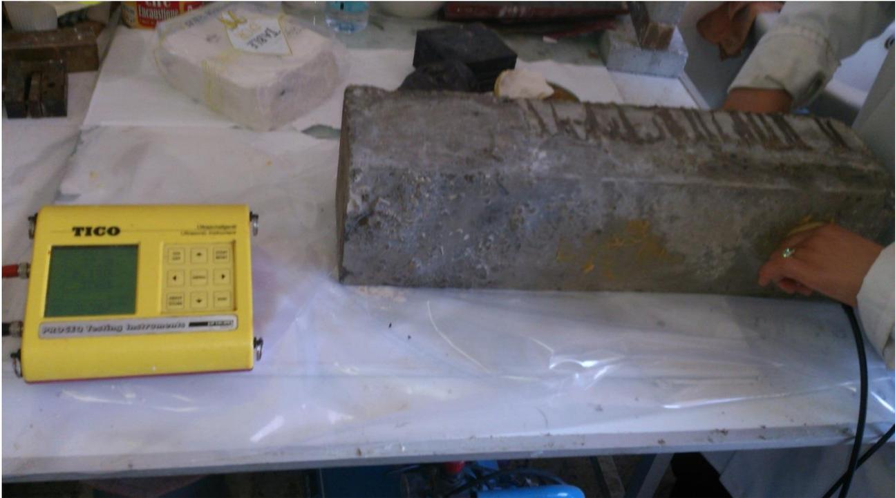
Figure V-33 : Essai d'ultrason
