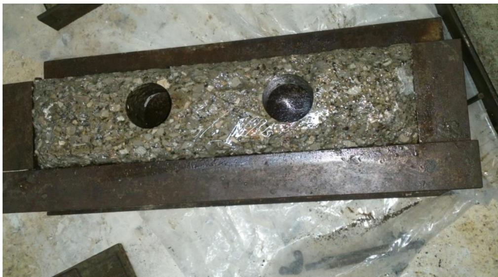
**Figure V-28:** coffrage de l'éprouvette de réparation
