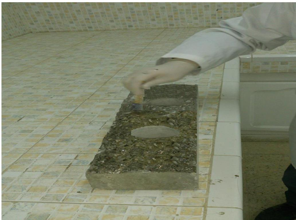
**Figure V-27** :application de la colle MEDAPOXY sur l'éprouvette
