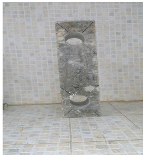
**FigureV-23**: l'éprouvette carotter (BAP témoin)
