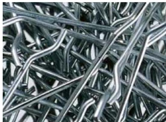
figure II-2 : fibres d'acier
