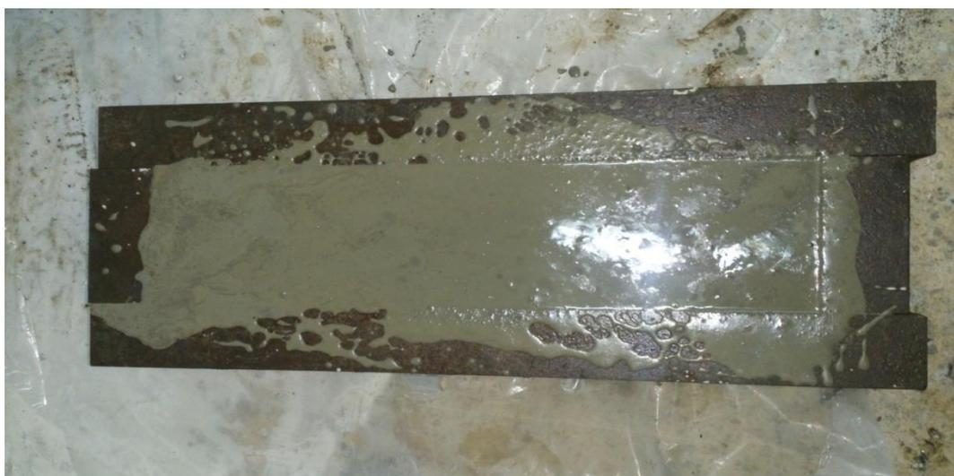
**Figure V-29 :** l'éprouvette réparée à l'état frais
