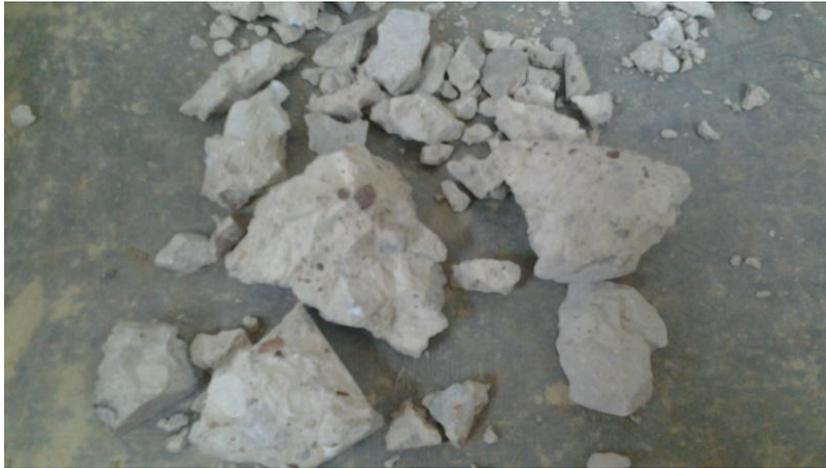
**Figure IV.25 : Échantillon béton témoin ayant subi un traitement thermique à 500°C (éclatement)**
