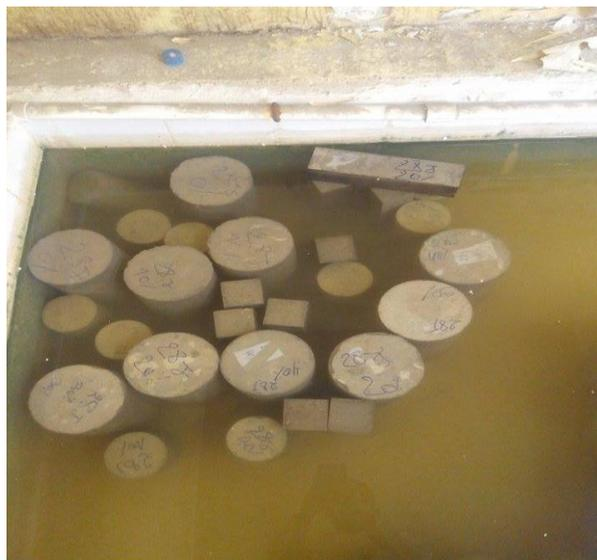
**Figure IV.19 : Conservation des éprouvettes dans le bassin.**
