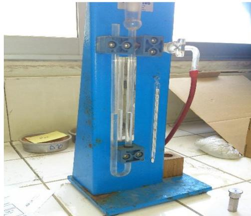
**Figure 1.1 : Perméabilimètre de Blaine.**
