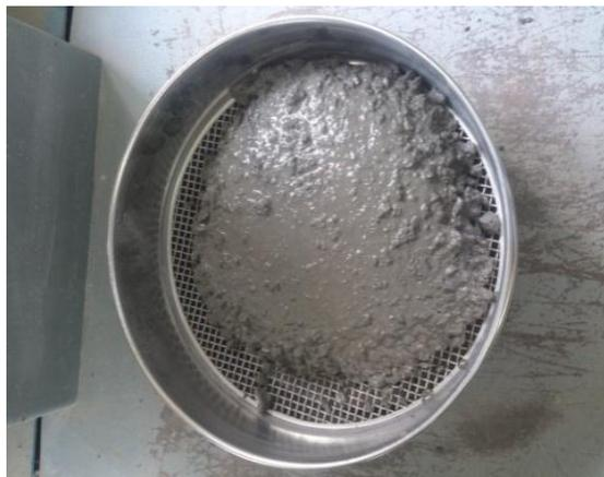
Figure IV. 16 : Essai de stabilité au tamis
