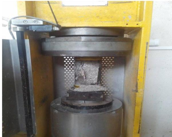
Figure IV.20 : Essai de la résistance à la compression
