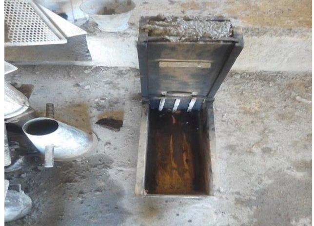
Figure IV.15 : Essai de boîte en L
