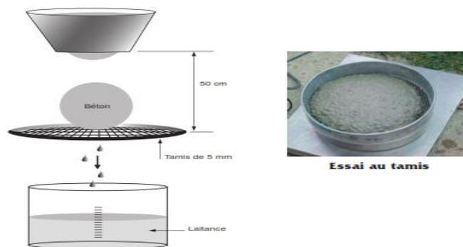
Figure II.10 : Essai de la stabilité au tamis
