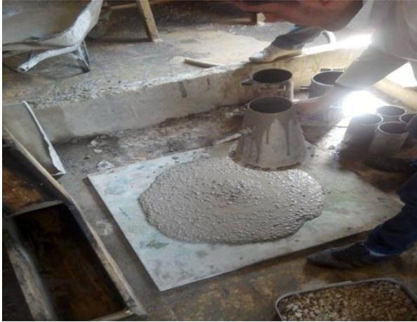
Figure IV.14 : Essai d'étalement
