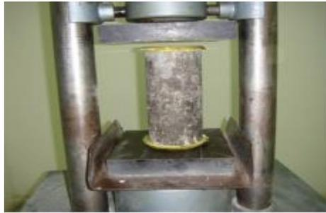
Figure 3.1 : dispositif pour l'essai de la compression.
