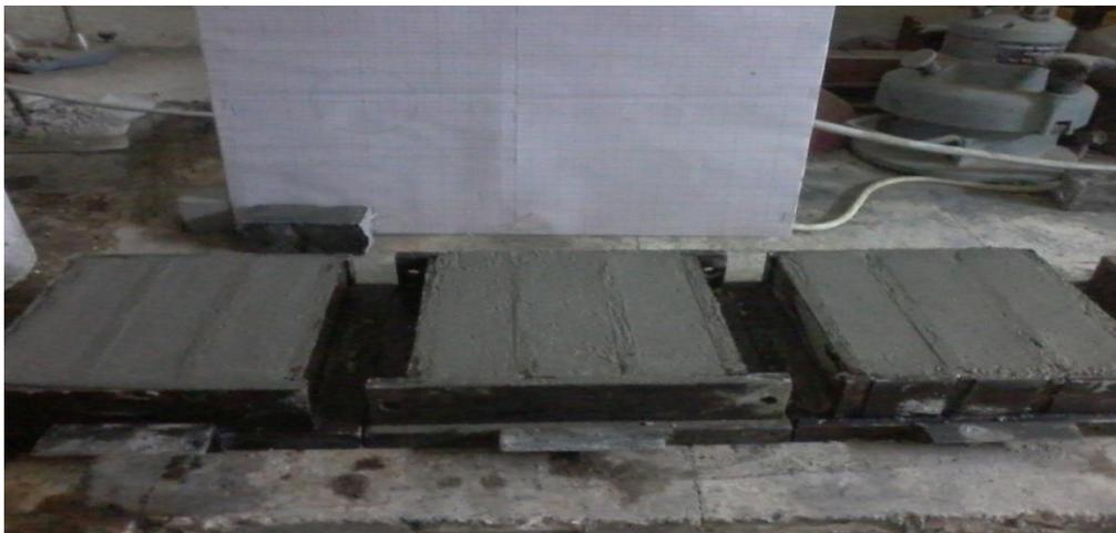
**Figure IV.6:** Mise en moule des mortiers.
