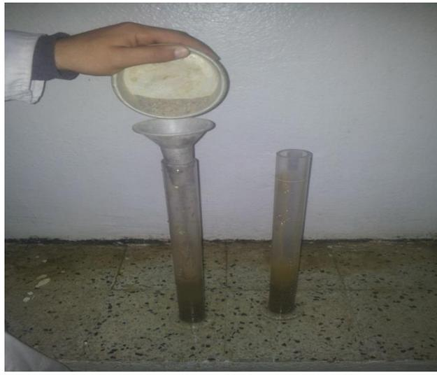
**Figure 3** : Essai d'équivalent de sable.
