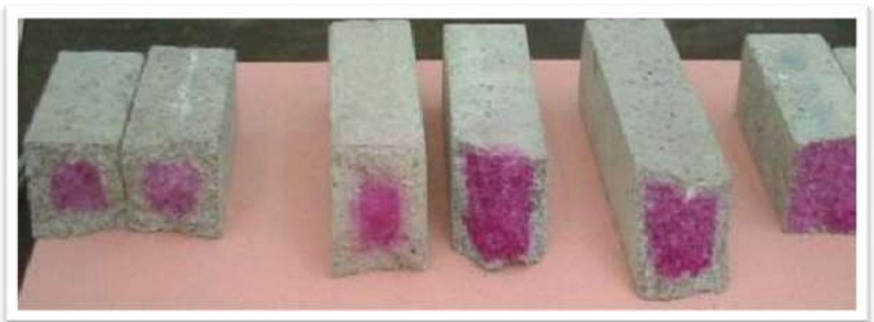
**Figure III. 5:** visualisation de la surface dégradée dans un prisme
