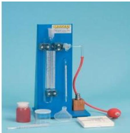
**Figure 10 :** Perméabilimètre de Blaine.
