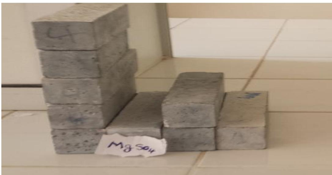
**Figure IV .21:** Etat des éprouvettes après 1 année l'attaque par le sel  $MgSO_4$ .
