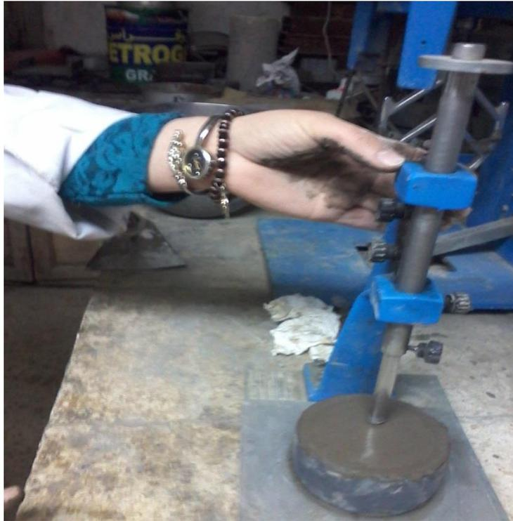
**Figure 7 : L'essai de consistance**
