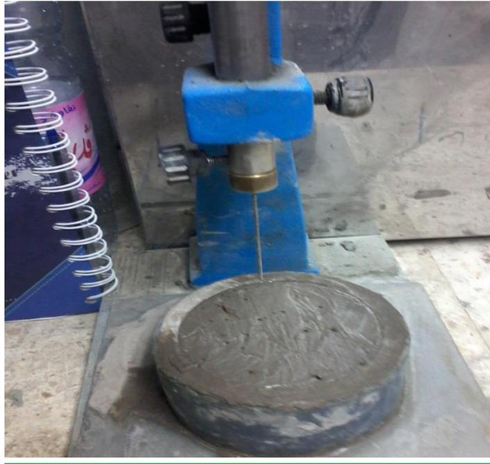
**Figure 8 :** L'essai de début et fin de prise
