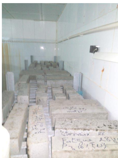
Figure.IV. 30 : Conservation des éprouvettes.
