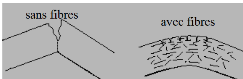
Figure II. 12: Fissuration dans un béton avec et sans fibres.
