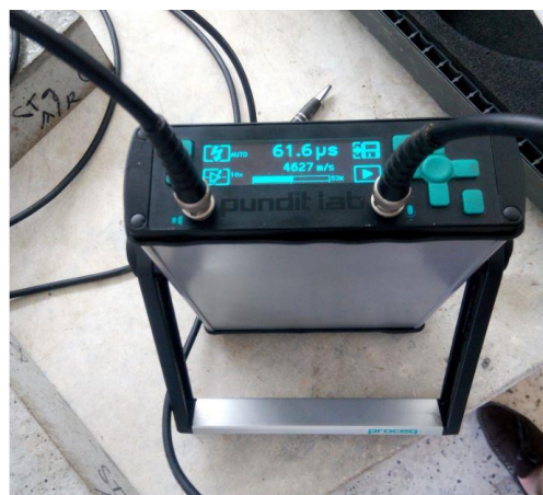
Figure.IV. 33 : Étalonnage de l'appareil. Figure.IV. 34 : Appareil de contrôle à ultrasons.
