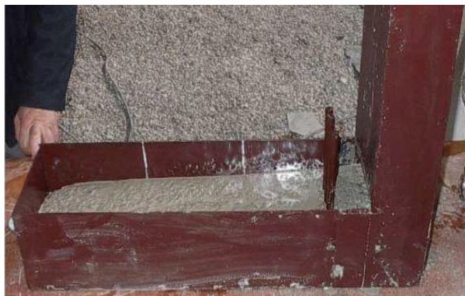
Figure III. 4: Remplissage du béton dans la boîte en L.
