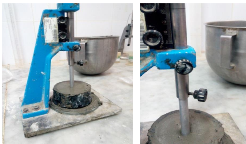
Figure.IV. 1 : Détermination de la consistance normale avec l'appareil de Vicat (sonde).
