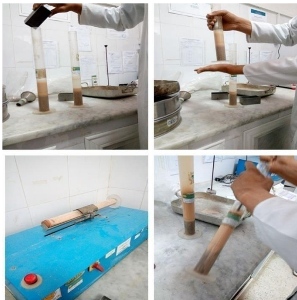
Figure.IV. 4 : Détermination de l'équivalent de sable.
