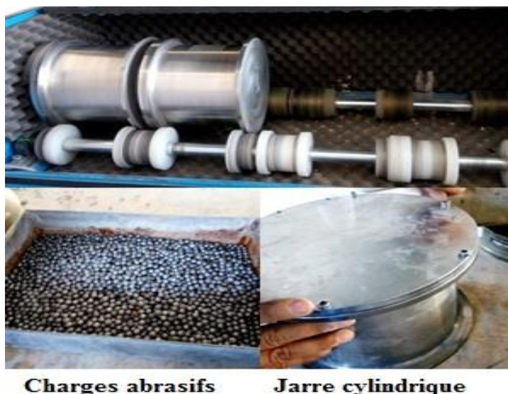
Figure.IV. 6 : Machine d'abrasion Micro-Deval.
