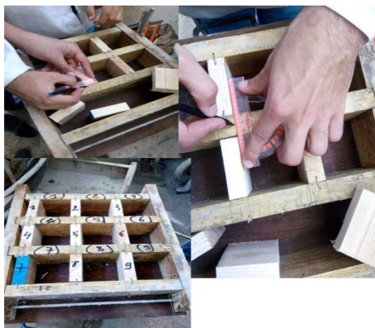
Figure.IV. 22 : Fabrication des moules cubiques.
