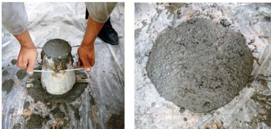
Figure.IV. 25 : Mesure de l'affaissement avec cône d'Abrams.
