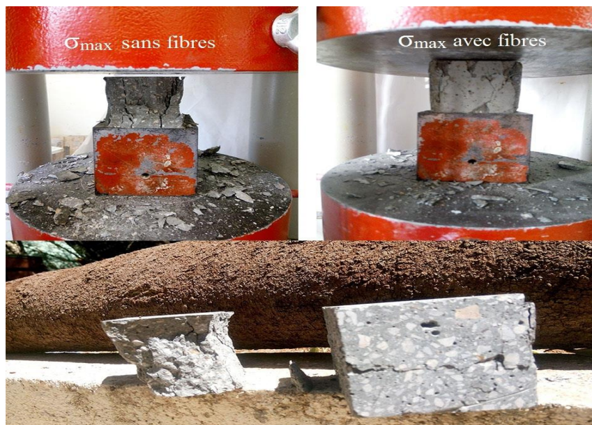
Figure.IV. 37 : Effet de l'ajout de fibres métalliques sur la détrition sous compression des BUHP.
