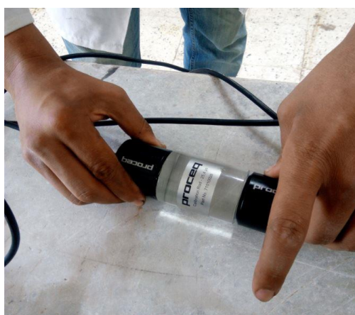
Figure.IV. 33 : Étalonnage de l'appareil. Figure.IV. 34 : Appareil de contrôle à ultrasons.
