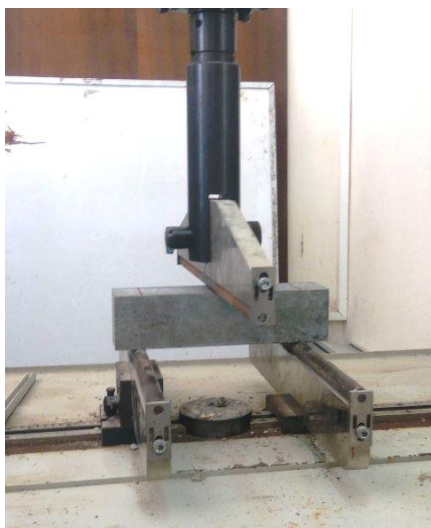
Figure.IV. 38 : Essai de flexion sur des éprouvettes prismatiques.
