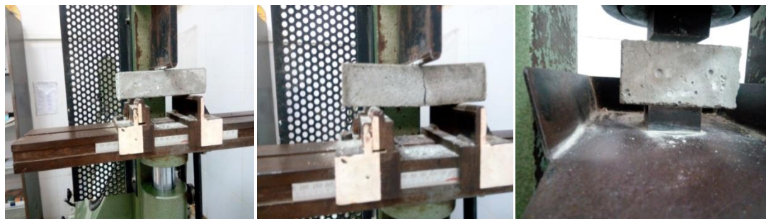
Figure.IV. 3 : Essais de flexion et de compression sur mortier.
