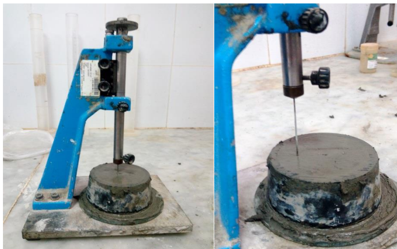
Figure.IV. 2 : détermination du temps de prise avec l'appareil de Vicat (aiguille).
