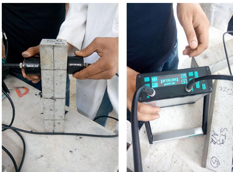
Figure III. 13: Appareil d'ultrasons « Proceq ».
