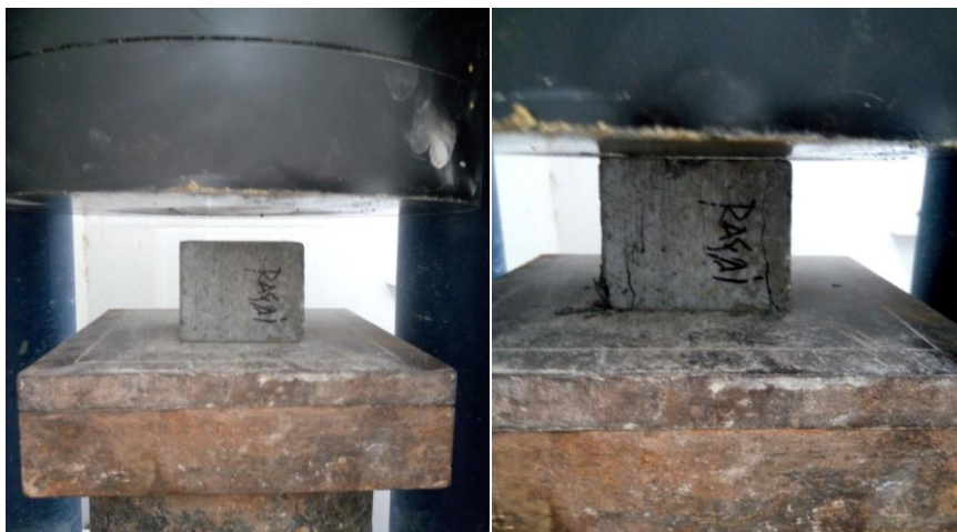
Figure III. 10: Essai de compression sur des éprouvettes cubiques.
