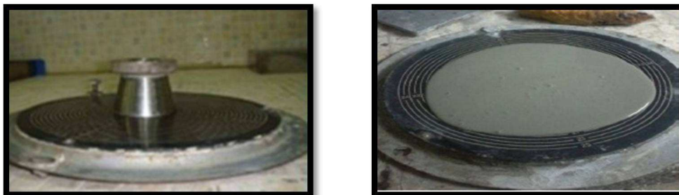
Figure I.8 Essai d'étalement d'un BFUP
