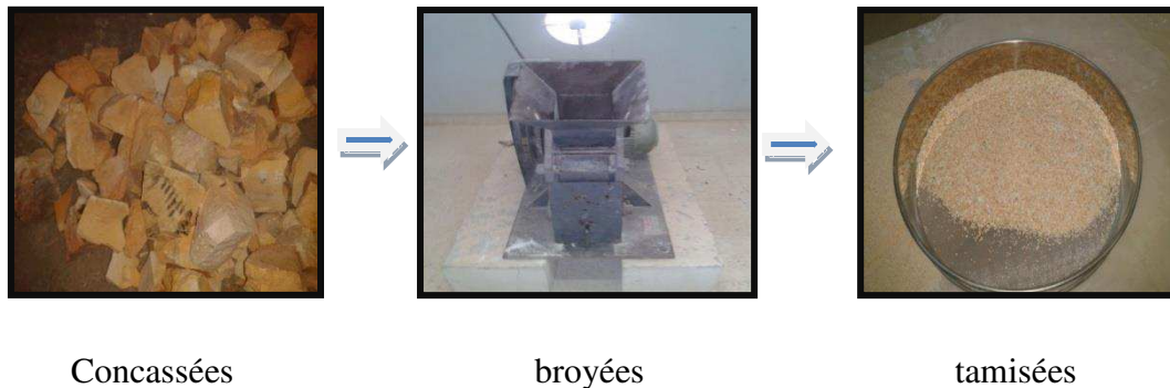
Figures IV.8 Préparation de déchet de brique réfractaire
