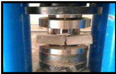
Figure IV.15 Eprouvette subie à la flexion
