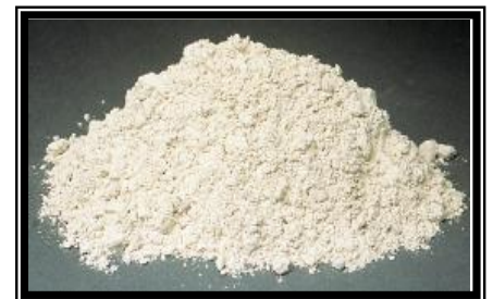
Figure 21. Laitier de haut fourneau granulé broyé.
