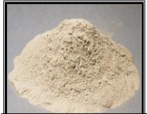
Figure 16- Cendres volantes : une poudre ressemblant au ciment utilisé dans le béton depuis les années 1930.
