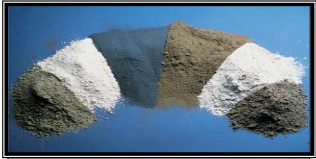
Figure 14. Ajouts cimentaires. De gauche à droite : cendres volantes (classe C), métakaolin (argile calcinée), fumée de silice, cendres volantes (classe F), laitier et schiste calciné.
