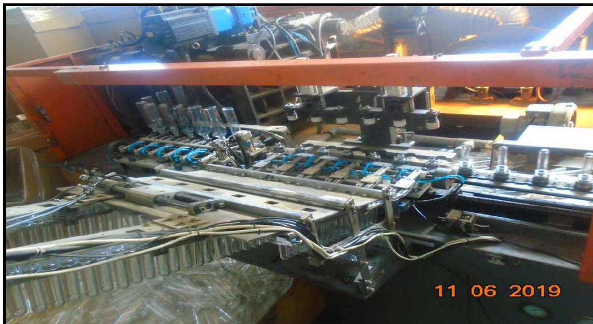
Figure III.9 : Insertion des éléments préforme
