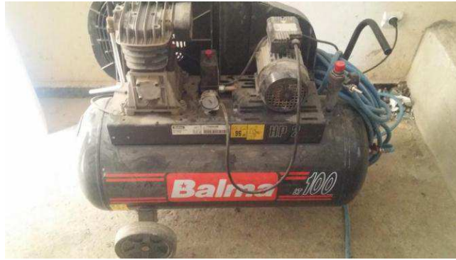
Figure (II-6) : L'appareil à air compresseur pour démoulage
