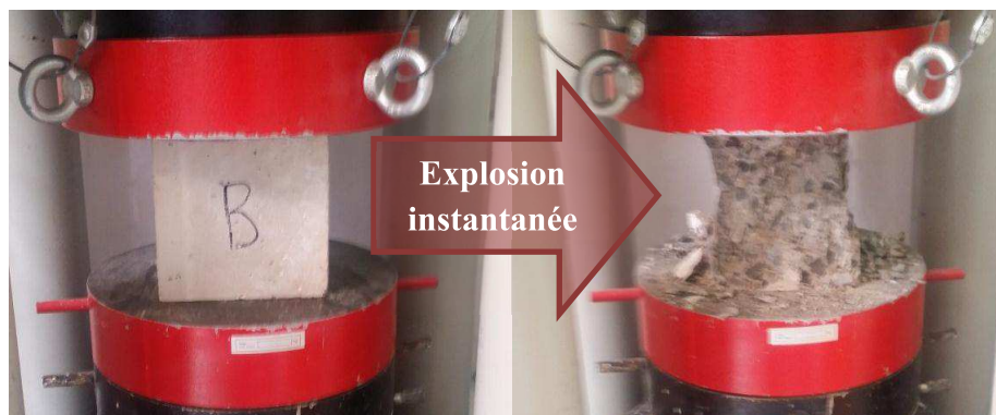
Figure (III-4) : Mode de rupture : explosion instantanée de l'éprouvette B 1 durant l'écrasement
