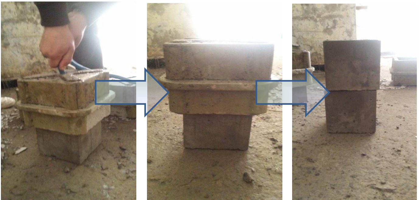
Figure (II-7) : démoulage d'une éprouvette cubique 15x15x15cm
