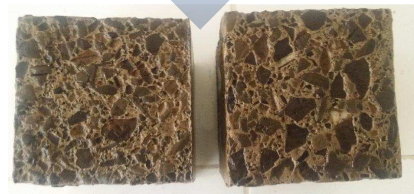
Figure (III-22) : l'état des éprouvettes du béton B à 1, 7 et 28 jours d'immersion en milieu fortement acide
