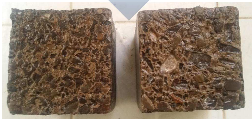
Figure (III-20) : l'état des éprouvettes du béton G à 1, 7 et 28 jours d'immersion en milieu fortement acide
