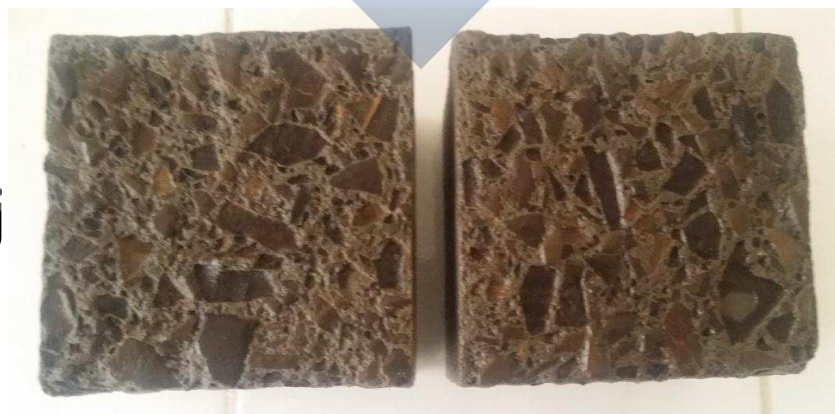
Figure (III-23) : l'état des éprouvettes du béton BF à 1, 7 et 28 jours d'immersion en milieu fortement acide
