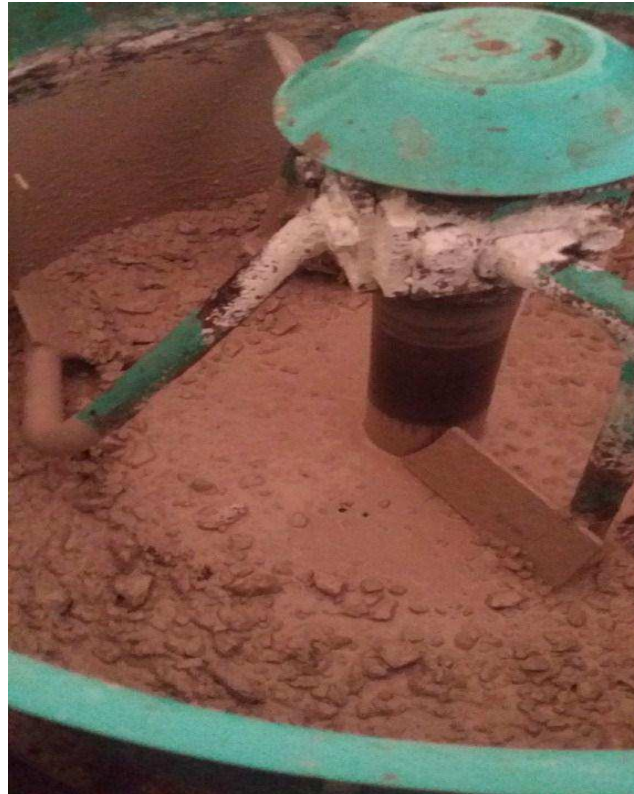
Figure (II-4) : béton après malaxage
