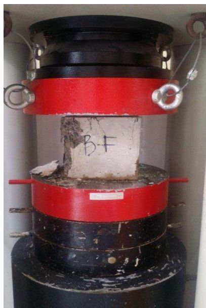
Figure (II-14) : essai de compression sur une éprouvette du béton BF
