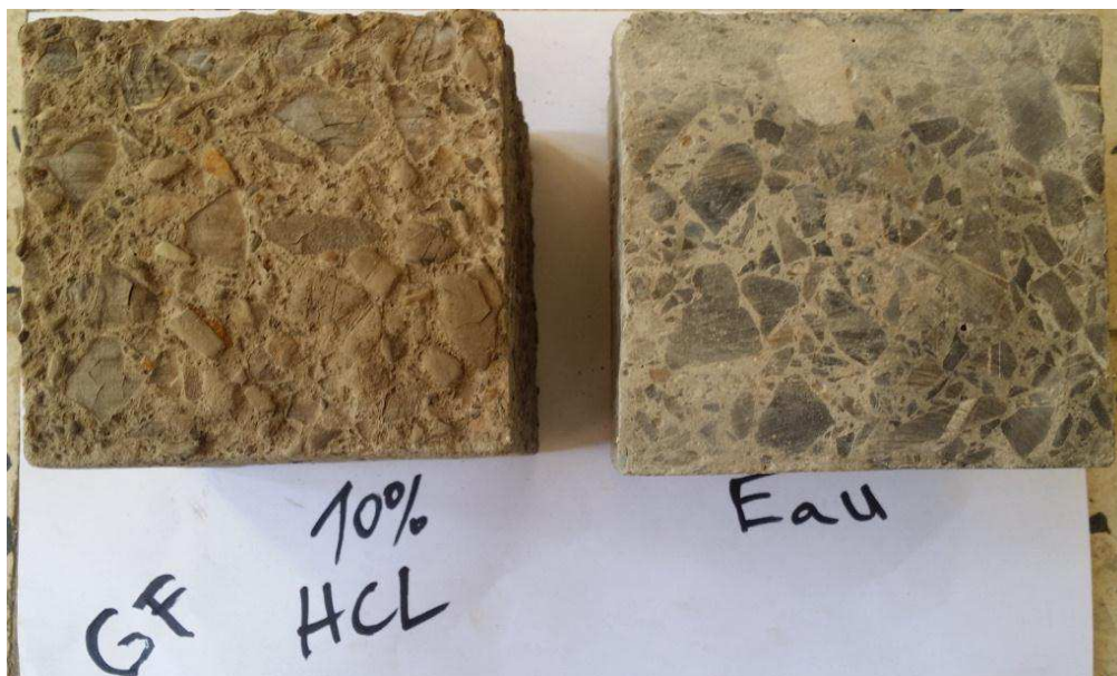
Figure (III-25) : Comparaison entre deux éprouvettes du béton GF l'une immergée dans l'eau et l'autre immergée dans 10% de HCl pendant 28j
