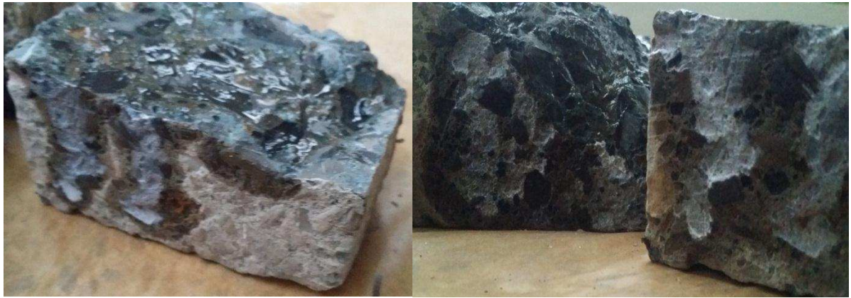
Figure (III-28) : coloration de la surface des éprouvettes en blanc (à l'abri de la lumière) caractérisant l'AgCl
