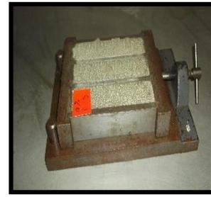
**Figure IV.12** : Préparation du BFUP dans le moule prismatique 4x4x16 cm
