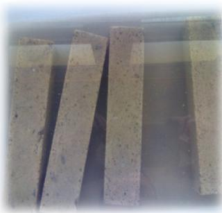
Eprouvettes dans les solutions d'attaques
