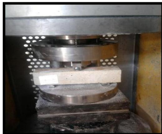
**Figure IV.15** :L'appareil de flexion
