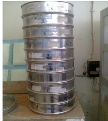
La somme des refus cumulés mesurés sur les différents tamis et du tamisât sur le fond (fillers) doit coïncider avec le poids de l'échantillon introduit en tête de colonne. La perte éventuelle de matériaux pendant l'opération de tamisage ne doit pas excéder plus de 2% du poids total de l'échantillon de départ.
