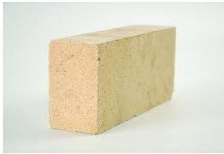
**Figure III.9 :** Brique d'alumine
