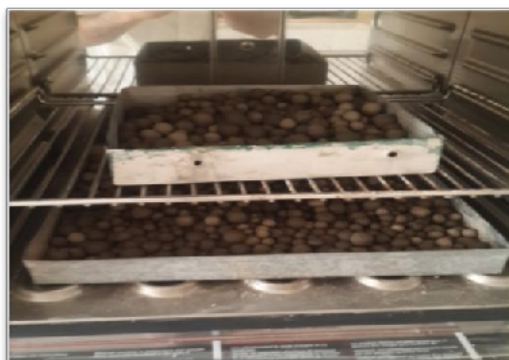
Figure IV.4.6 : Séchage des granulats
