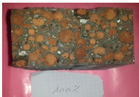
Figure IV.8.4.3.3 : Face de l'éprouvette prismatique de béton avec 100 % GL
