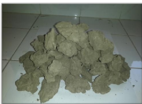
Figure IV.4.2.1 : Vase de barrage après le séchage
