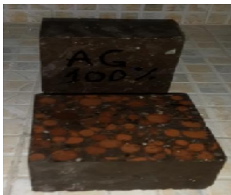
Figure IV.8.4.3.4. Éprouvettes de béton 100% GL pour l'essai d'isolation thermique
