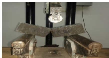
Figure IV.8.4.3.1 : Essai de flexion (100% GL)
