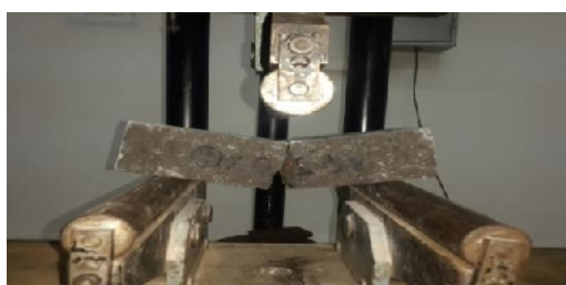
Figure IV.8.3.3.1 : Essai de flexion (50% GL)
