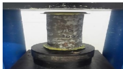
Figure IV.8.4.3.2 : Essai de compression (100% GL)
