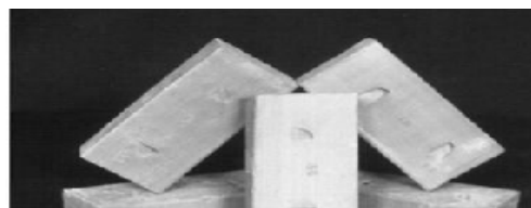
figure III.6.2 : Briques à base de la vase du barrage lakhel (bouira)
