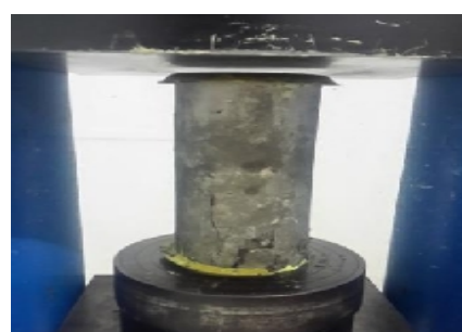
Figure IV.8.2.3.2 : Essai de Compression (témoin)
