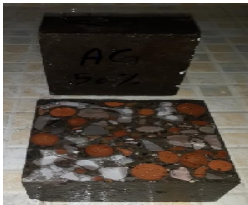
Figure IV.8.3.3.3. Éprouvettes de béton 50% GL pour l'essai d'isolation thermique
