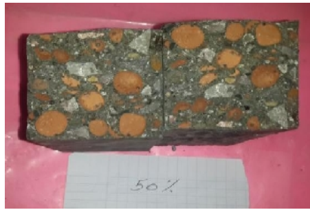
Figure IV.8.3.3.2 : Face de l'éprouvette prismatique de béton avec 50 % GL
