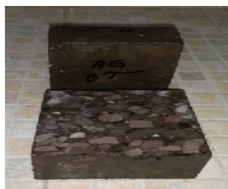
Figure IV.8.2.3.5 : Éprouvettes de béton témoin pour l'essai d'isolation thermique
