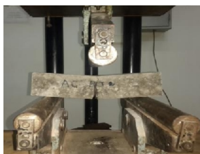
Figure IV.8.2.3.1 : Essai de flexion (témoin)
