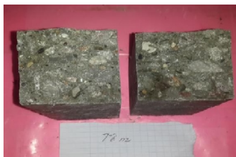
Figure IV.8.2.3.3 : Face de l'éprouvette prismatique de béton témoin
