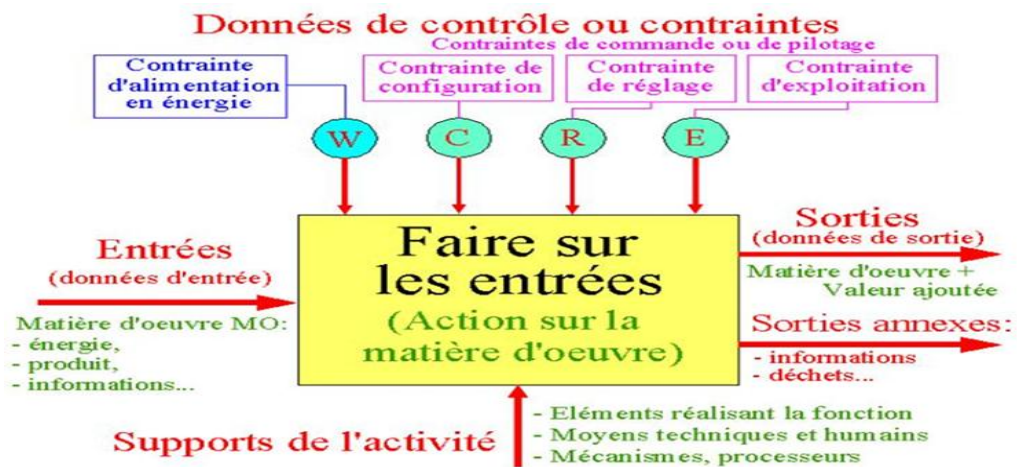
Figure 2.3 : schéma détaillée de la SADT (7)
