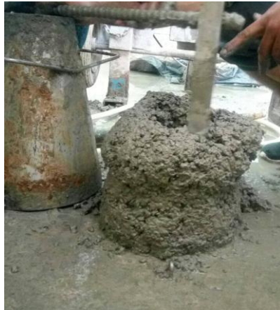
Figure 14 : Essai d'affaissement du béton
