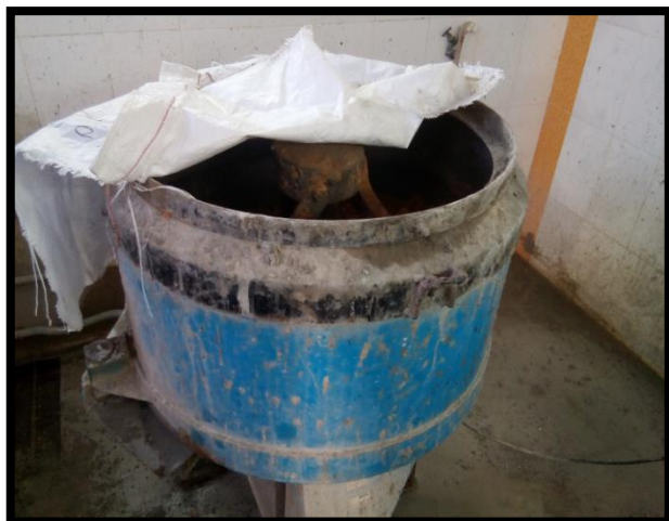
Figure 12 : malaxeur du béton
