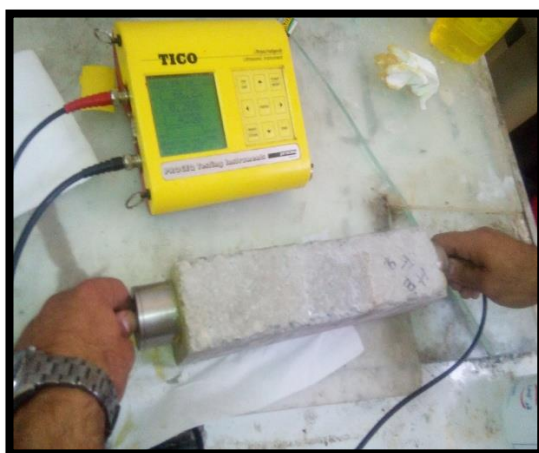
Figure 27 : Essai non destructif ultrason
