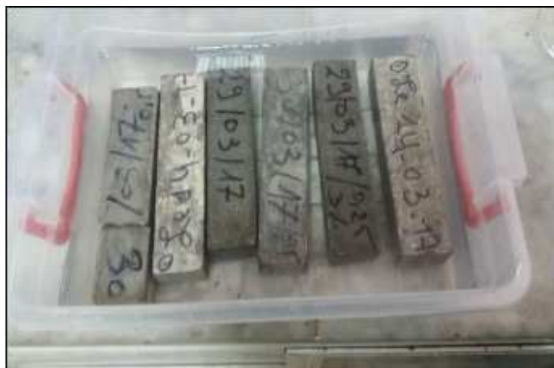
Figure N°29 : immersion des échantillons dans la solution de sulfate de sodium
