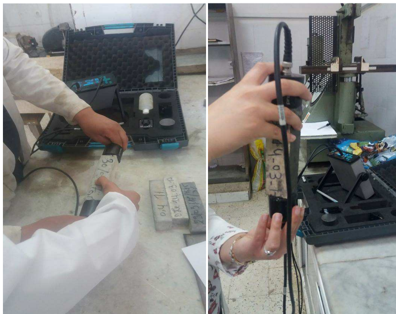
Figure N°31 :Méthode de mesure de la vitesse par ultrasons
