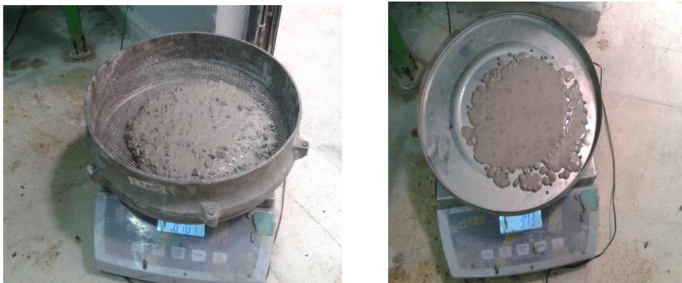
Fig 1.14. dispositif de l'essai de stabilité au tamis
