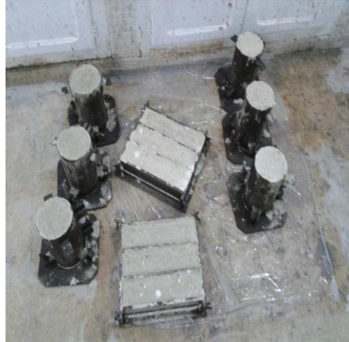
**Fig 4.1.** Moules de béton autoplaçant
