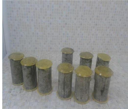
**Fig4.14.** Epreuves d'essai de compression
