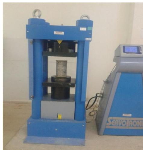
**Fig 4.15.** Presse utilisée pour mesurer de résistance à la compression
