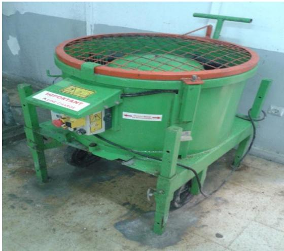
**Fig 4.2.** Malaxeur de béton autoplaçant
