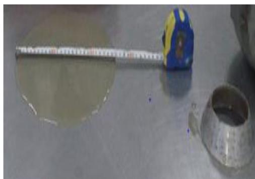
**Fig 3.3.** Essai d'étalement au mini-cône
