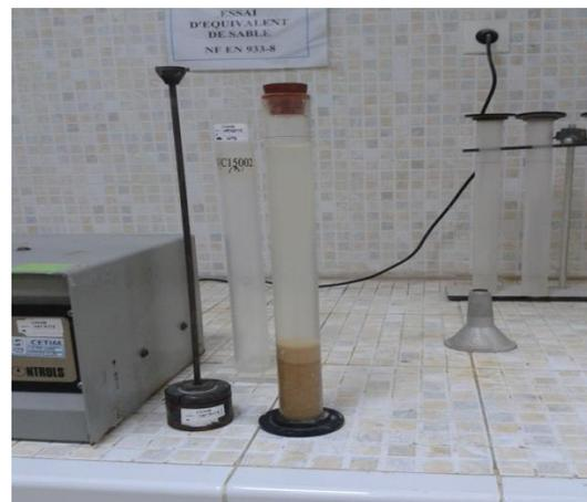
Fig 2.10.Essai d'équivalent en sable.
