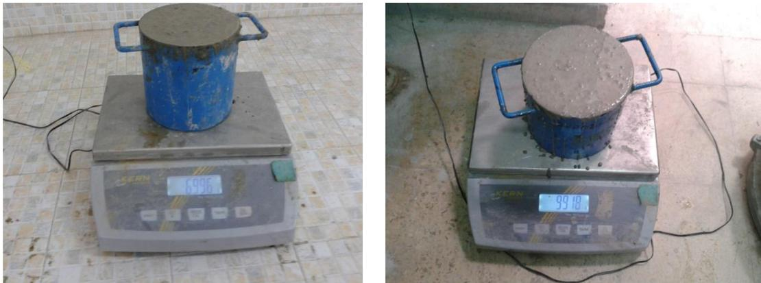
**Fig 4.11.** Essai de la masse volumique.
