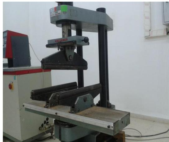
**Fig.4.17.** Détermination de la résistance à la traction par flexion
