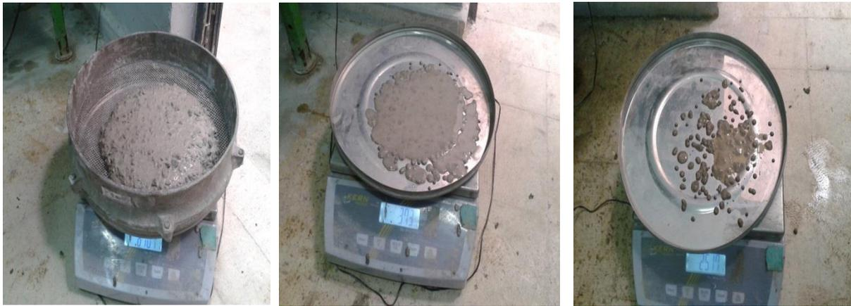
**Fig 4.9.** Essai de stabilité au tamis.
