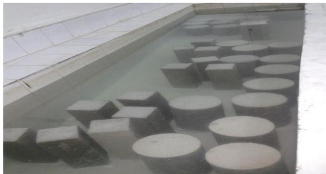
**Fig 4.3.** Conservation des éprouvettes
