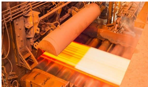
Figure II.5 Laminage de la tôle à chaud.
