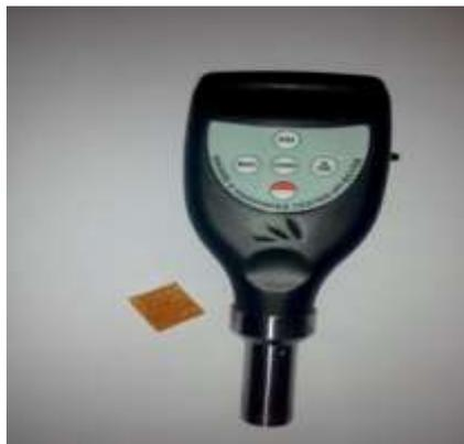
**Figure n °10** : photo originale pénétromètre.
