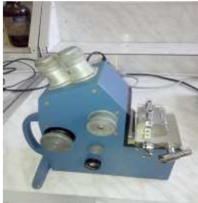
**Figure n°14** : photo originale représente le réfractomètre.
