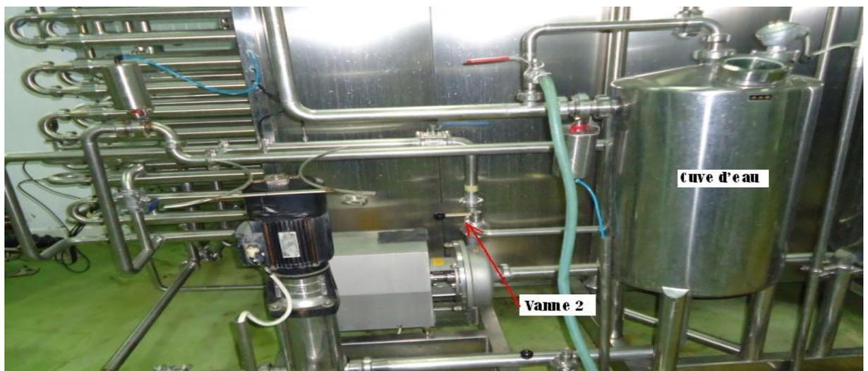
Figure N°16:le pasteurisateur tubulaire
