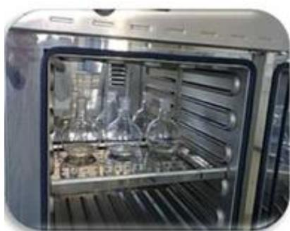
**Figure 05** : Photo des fioles dans l'étuve réglée à  $103 \pm 2^\circ\text{C}$
