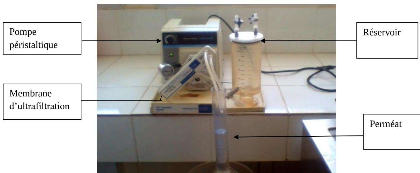
. Figure N° 8 : Dispositif d'ultrafiltration de laboratoire (photo réelle, Département de technologie alimentaire, UMBB)
