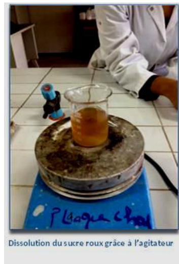
Figure 6 : l'échantillon sur l'agitateur magnétique
