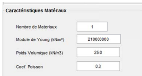
Paramètres du matériau de la structure
