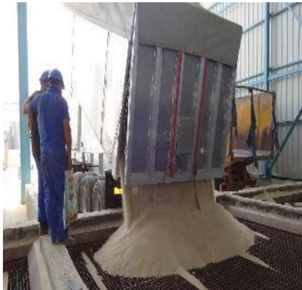
Figure 5 : entreposage du sucre roux en pile    figure 6 : réception du sucre roux (tamis)
