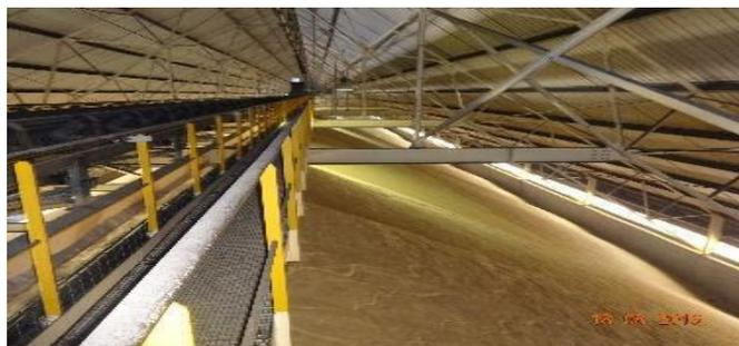
Figure 7 : le convoyeur et l'aimant
