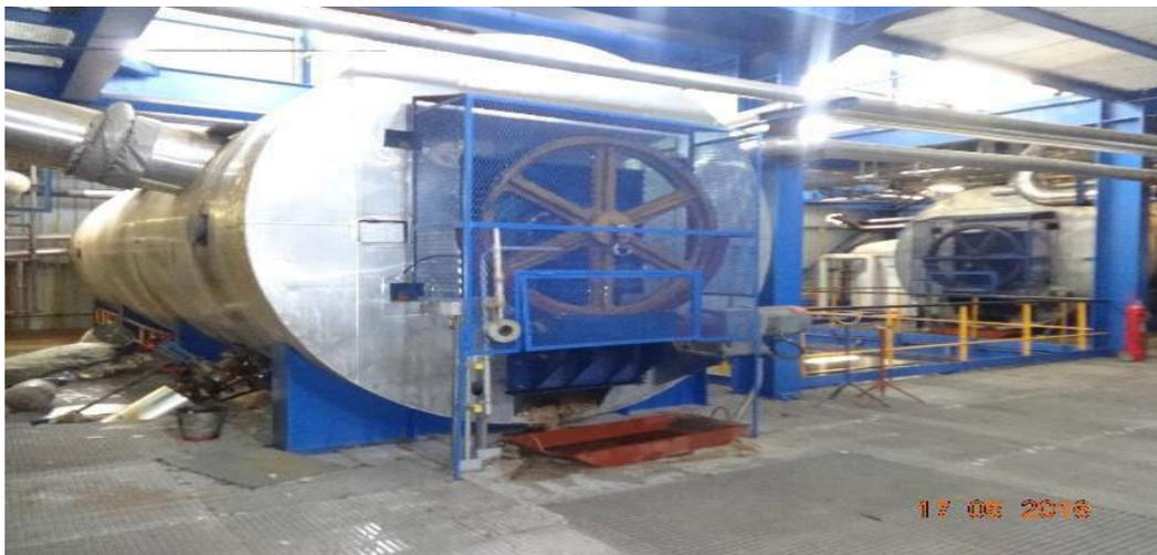
Figure 14 : un malaxeur horizontal équipé d'un agitateur entrainé par un moteur électrique de puissance de 20 KW
