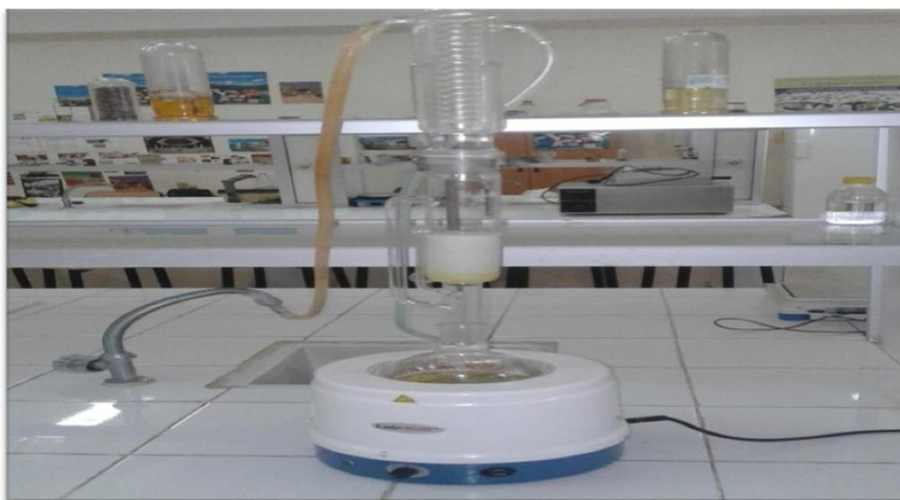
**Figure 8:**Montage d'extraction par soxhlet
