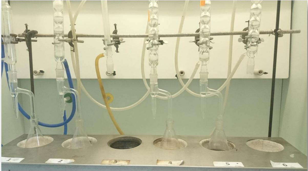
**Annexe B-7 : Installation de détermination de la teneur en eau par extraction.**
