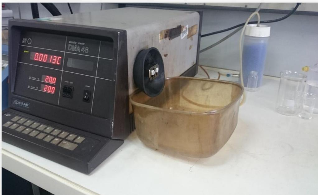
**Annexe B-1 : Densimètre électronique à tube en U oscillant**
