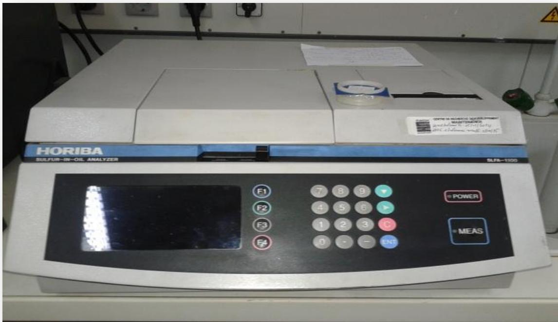
**Annexe B-8 : Appareil de détermination de la teneur en soufre par fluorescence rayon x.**
