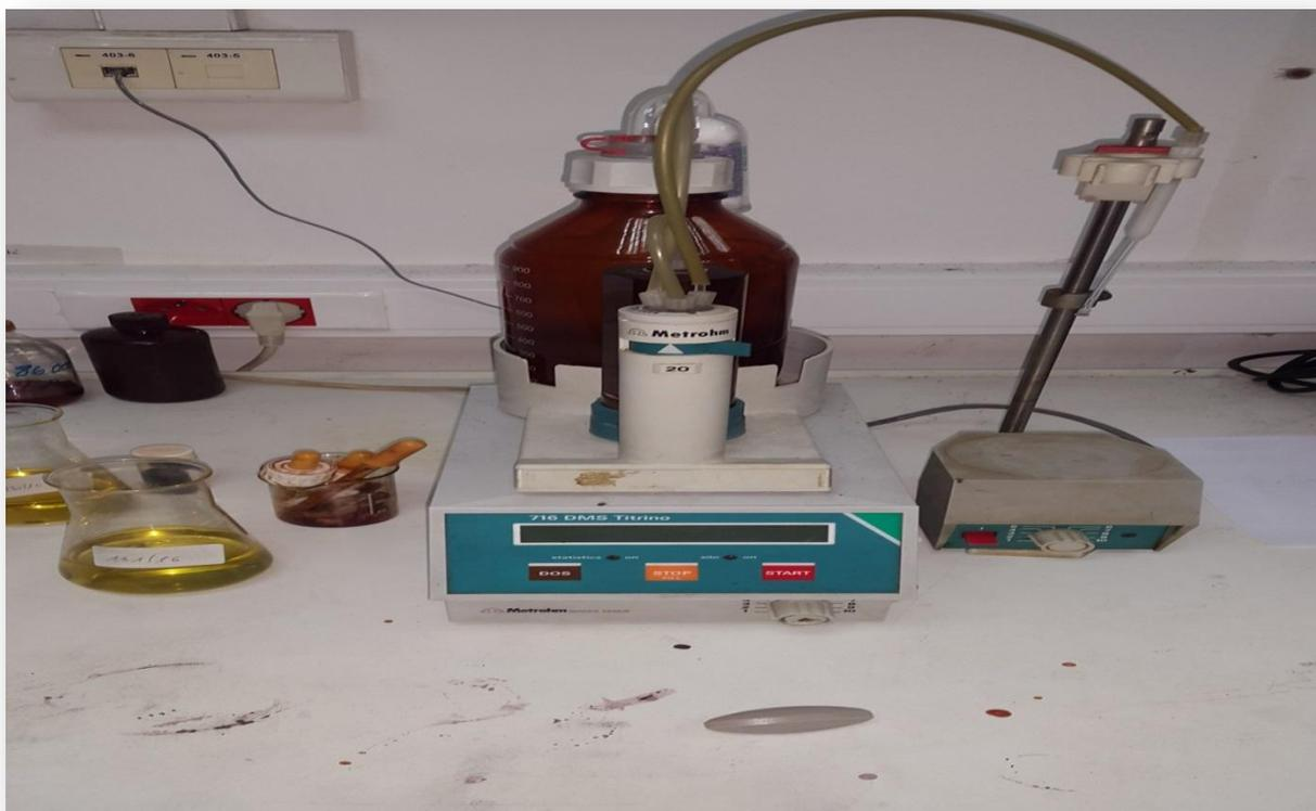
**Annexe B-9 : Appareil de détermination de l'indice d'acidité « par titrage »**
