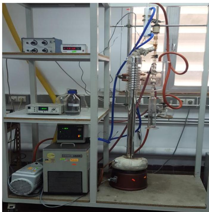
**Annexe B-10 : Appareillage de la distillation TBP manuelle ASTM D2892.**
