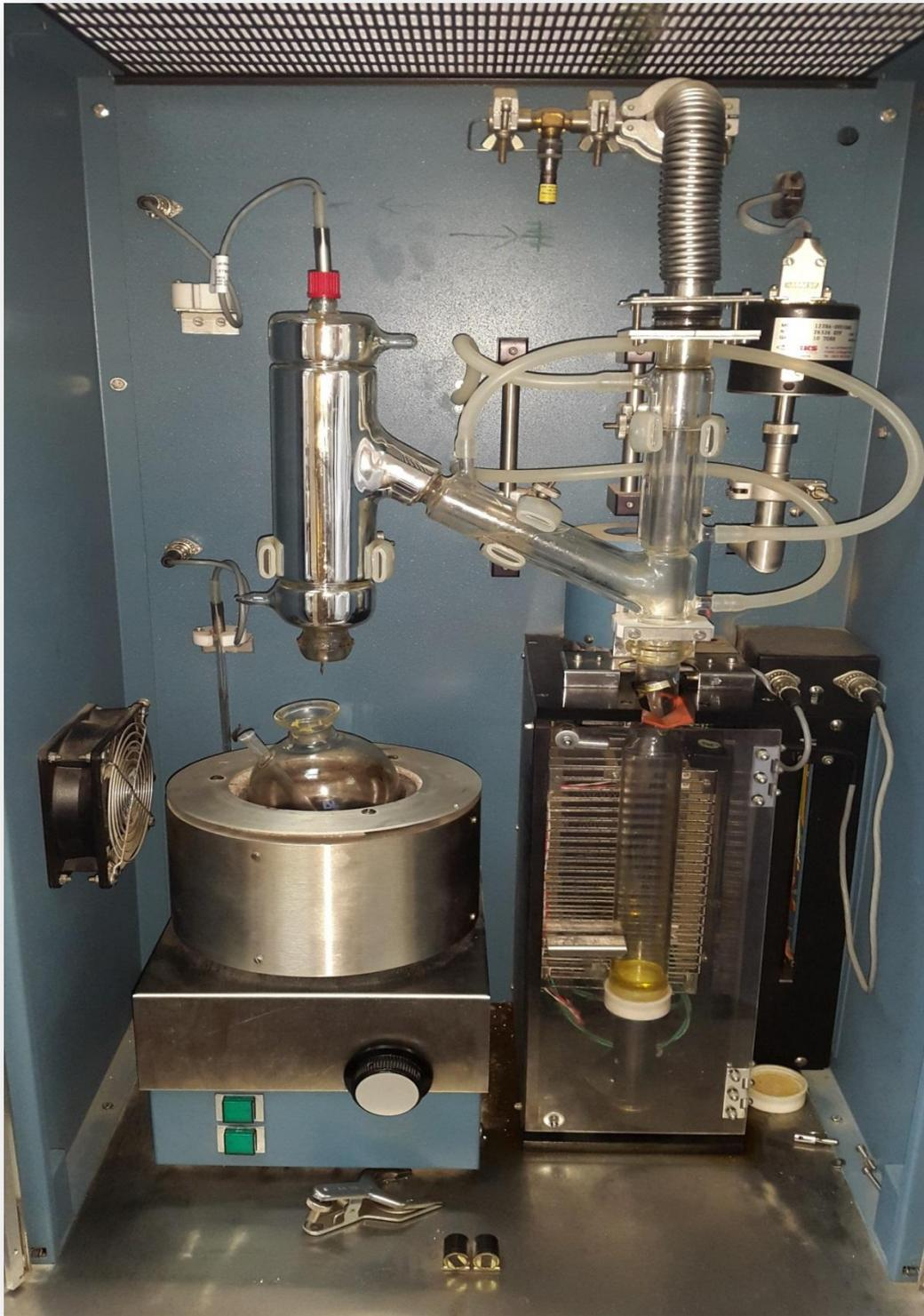
**Annexe B-11 : Appareil semi-automatique de la distillation des produits pétroliers à pression réduites ASTM D1160.**
