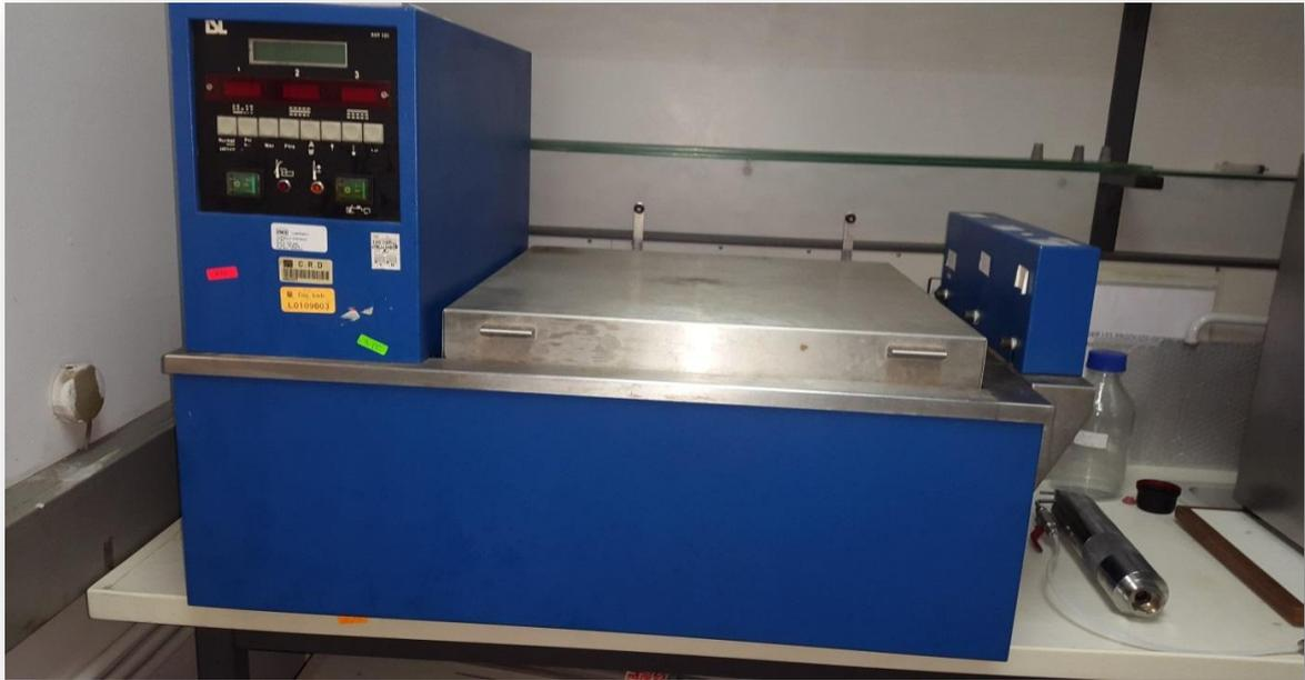
**Annexe B-3 : Appareil de détermination de la Tension de vapeur Reid**
