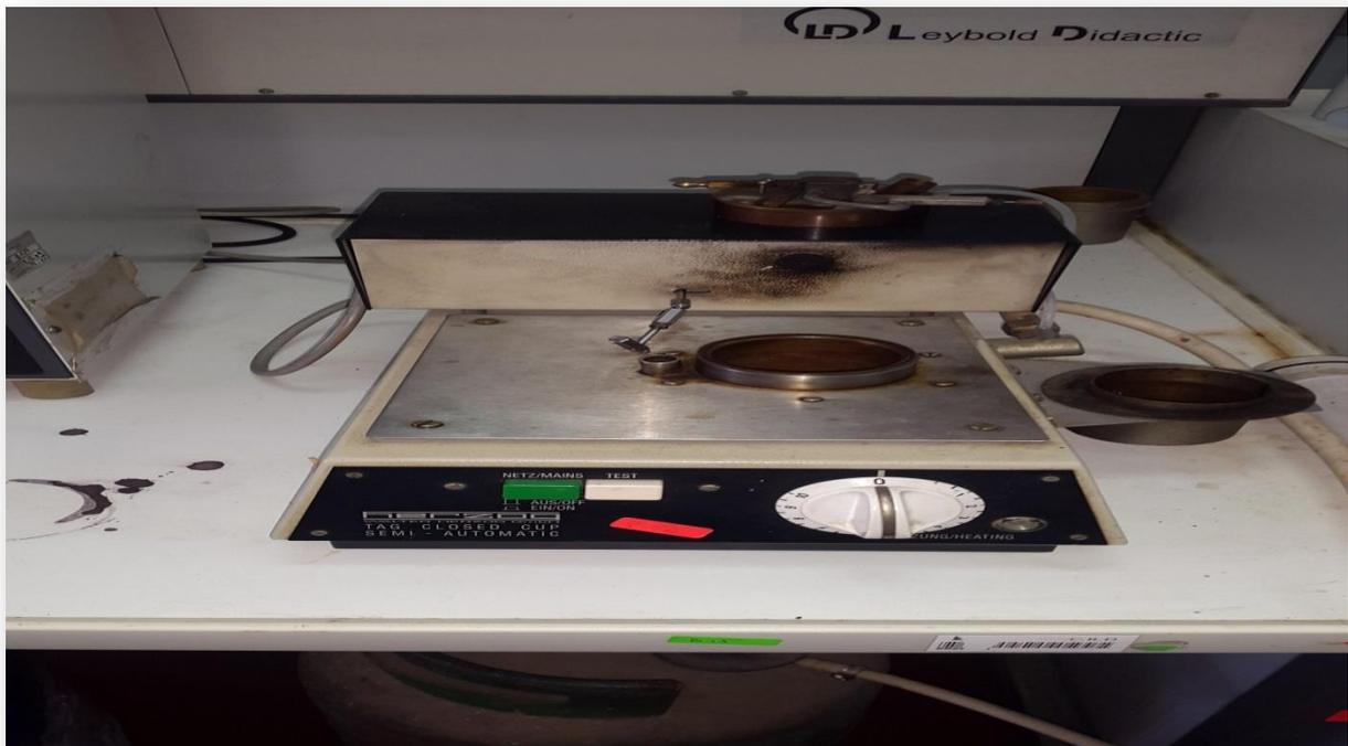
**Annexe B-4 : Appareil de détermination de point d'éclair (vase fermé)**
