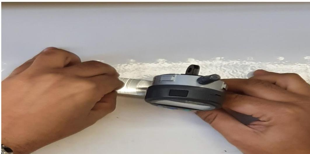
Fig. I. 8. Calcul par courants de Foucault de la profondeur de la bosse.
