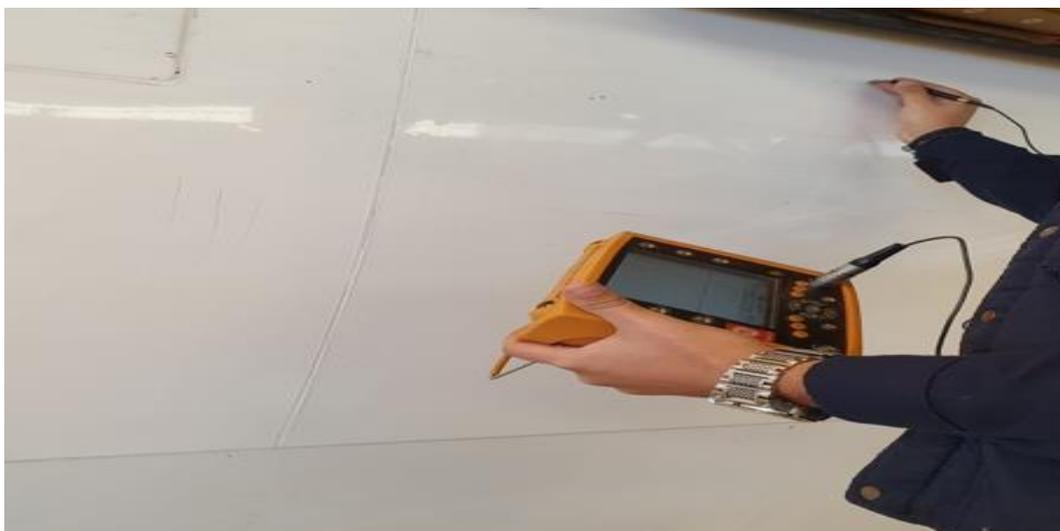
Fig. I. 7. Contrôle du fuselage d'un avion par courants de Foucault.
