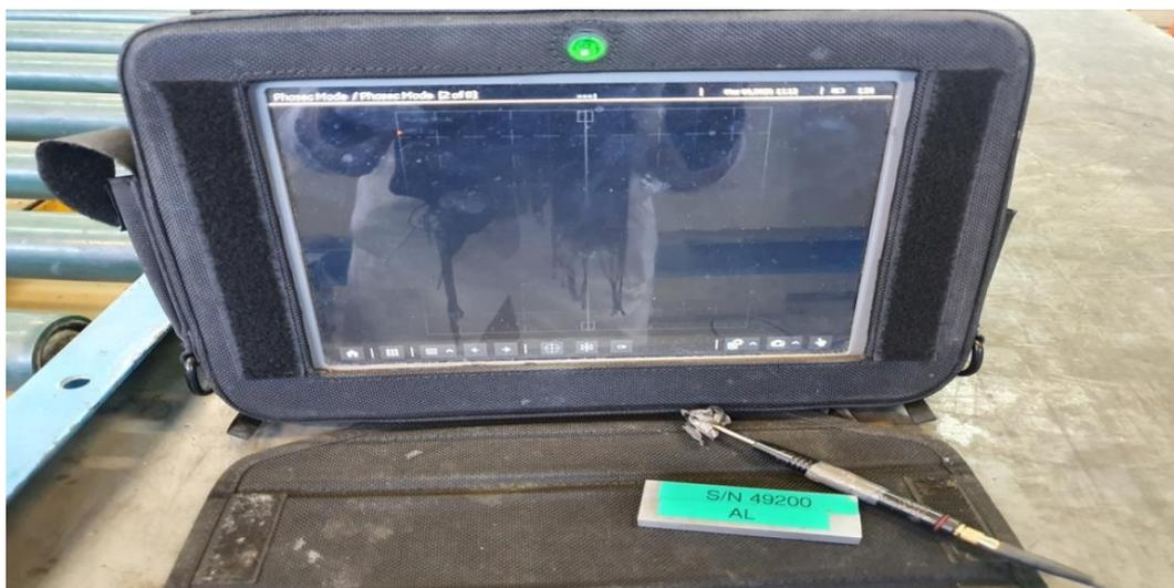
Fig. I. 5. L'appareil qui sert au CND-CF ainsi qu'une sonde et un étalon.
