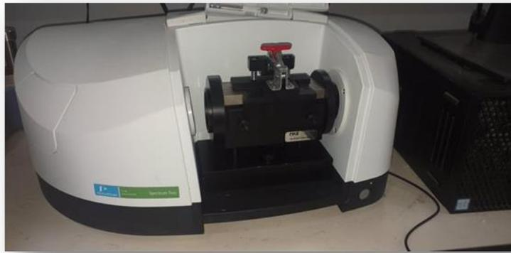
**Figure 23:** Spectroscopie Infrarouge à transformée de Fourier (IRTF)
