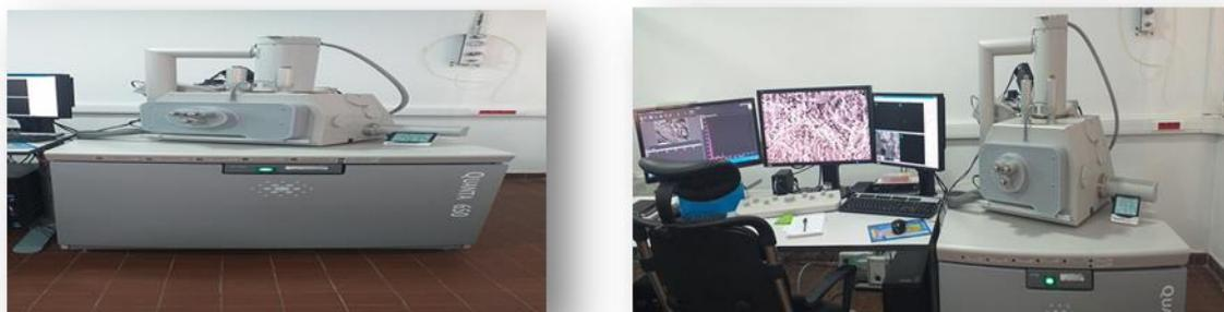
**Figure 25:** Microscope électronique à balayage (MEB)
