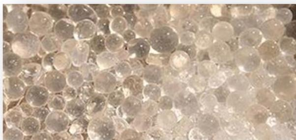
**Figure 16:** Les perles de gel de silice
