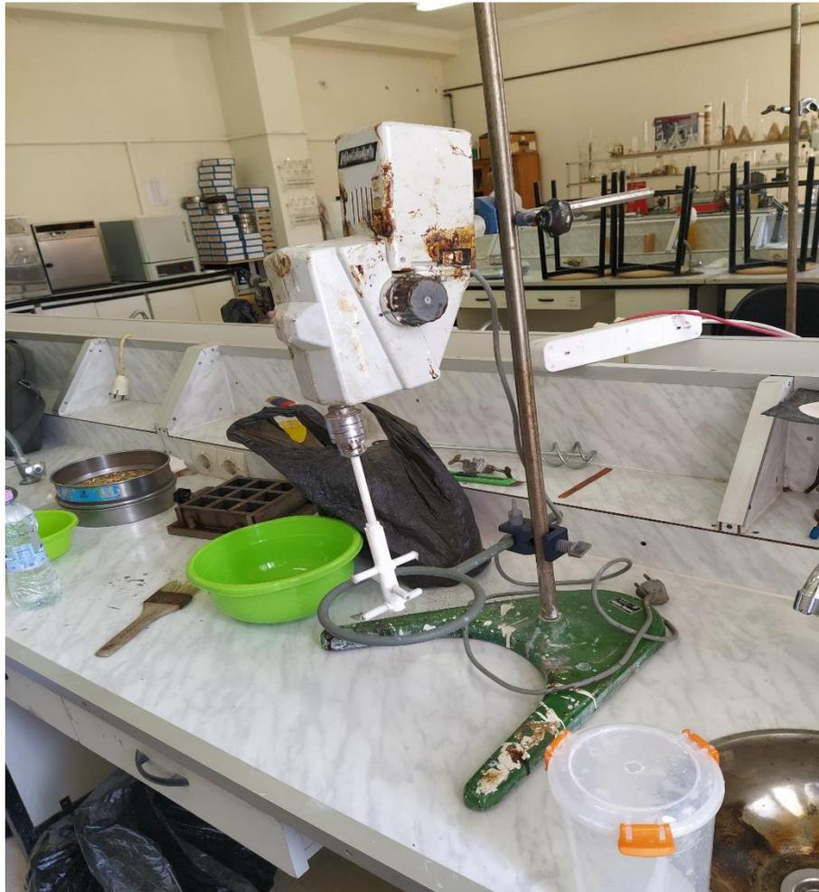
**Figure III.6 : Malaxeur de béton utilisé.**
