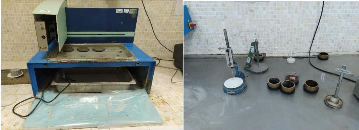
**Figure III.4.essais de mesure consistance normal et temps de prise.**
