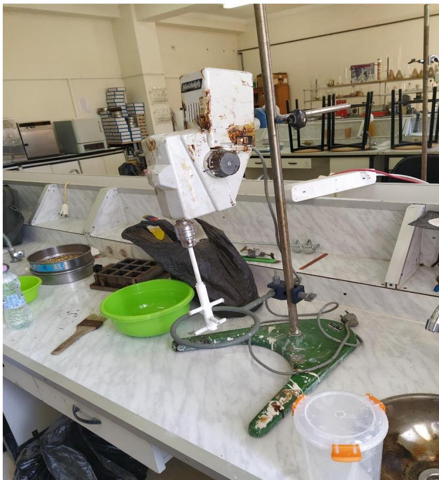
**Figure III.6 : Malaxeur de béton utilisé.**
