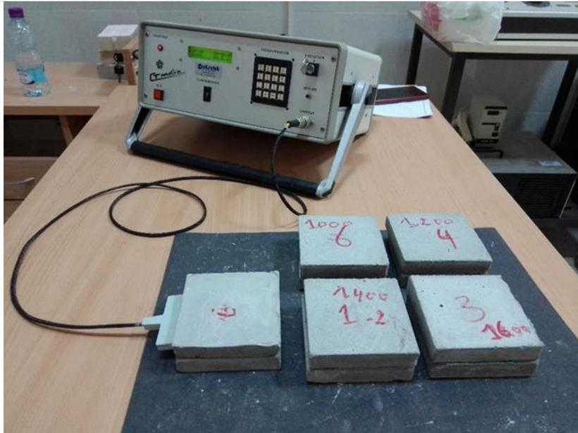
Figure IV.13. Essai de la conductivité thermique et chaleur spécifique.
