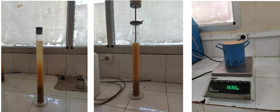
Figure III.1 : Essais d'équivalente sable et masse volumique.
