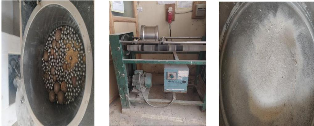
Figure III.3 : Mesure du coefficient de friabilité de sable.
