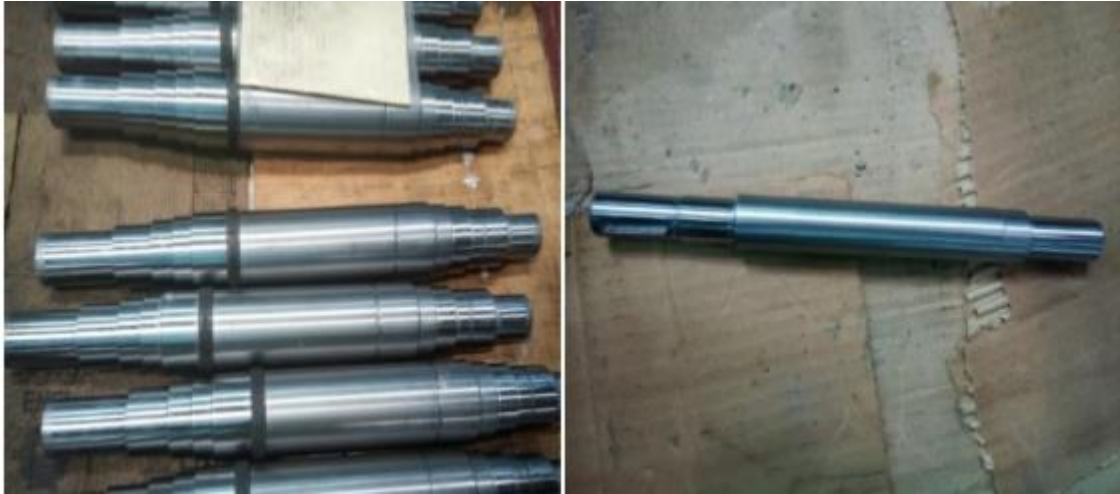
Figure I. 9. Arbre d'un moteur électrique après usinage
