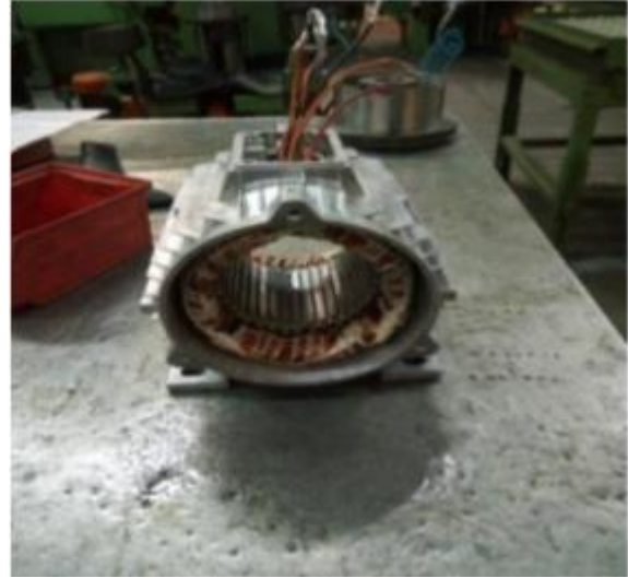
Figure I. 24. Stator bobiné monté dans une carcasse
