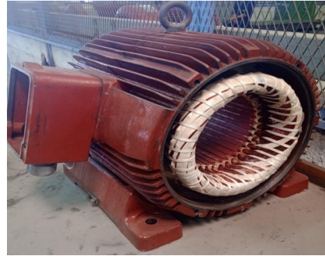
(b) le stator placée dans la carcasse
