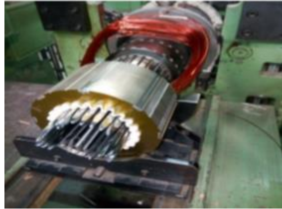
Figure I. 22. Bobinage automatique d'encoche isolées
