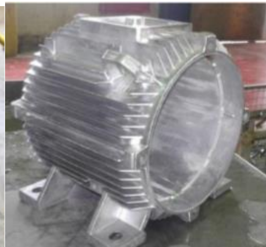
Figure I. 14. Carcasse métal coulé (Aluminium)
