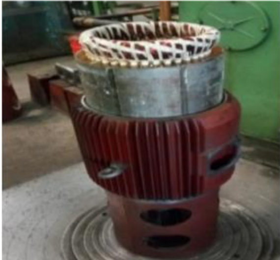
Figure I. 23. Pré montage du stator dans la carcasse
