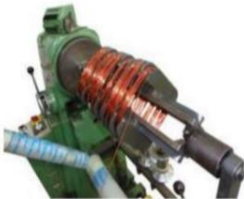
Figure I. 19. Bobineuse de fil électrique Figure I. 20. Préparation des bobines
