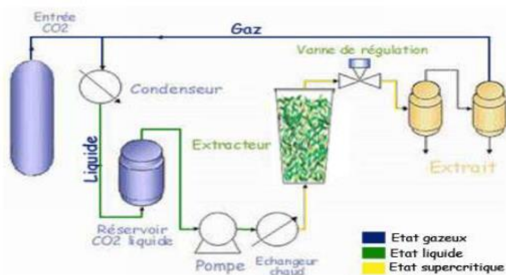
Figure 07: Extraction au CO_2 supercritique.
