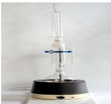
Figure 03: Appareil de soxhlet ( Verrerie Dumas ).
