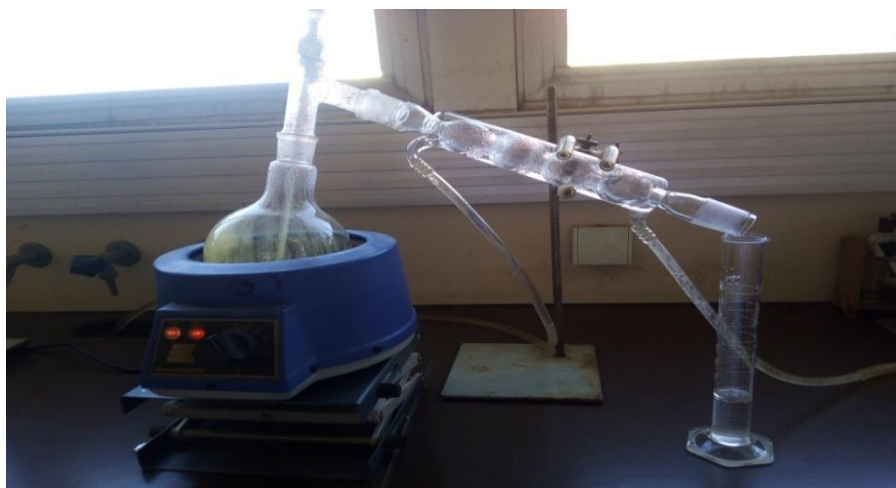
Figure 10: Dispositif d'hydrodistillation utilisé au niveau du laboratoire.
