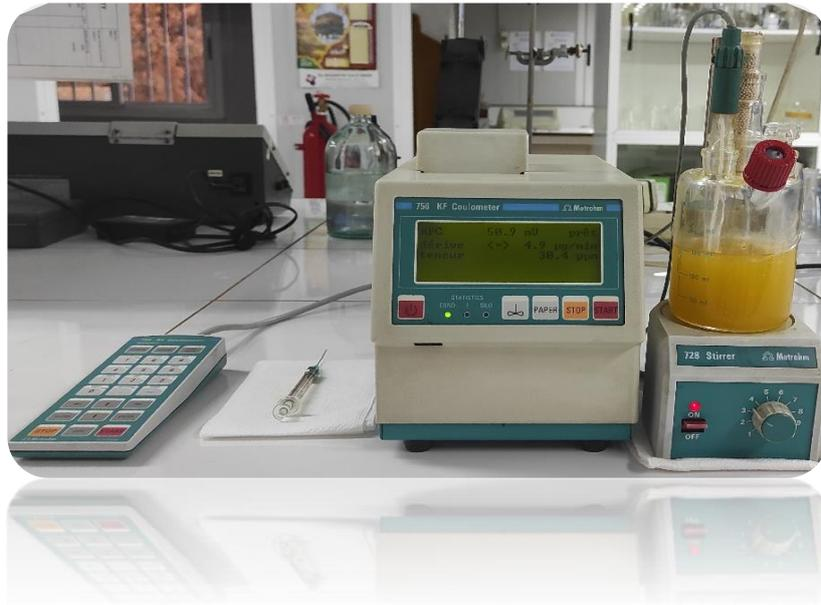
**Photo.III.6.** Titreur Karl Fisher pour la mesure de la teneur en eau.
