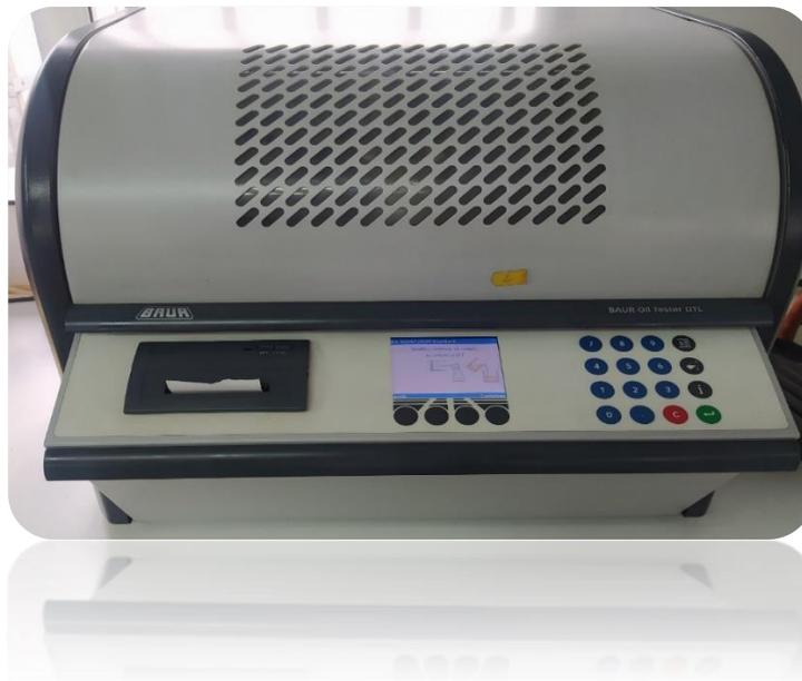
**Photo.III.7.** Appareil tangent delta de mesure du facteur de dissipation.
