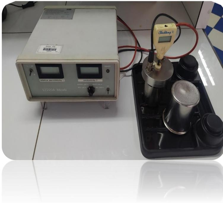
**Photo.III.12.** Conductimètre CEI61620.
