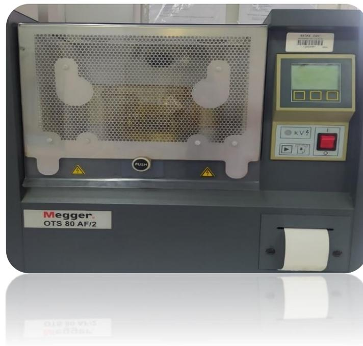
**Photo.III.10.** Appareil de mesure de la tension de claquage (spintermètre).
