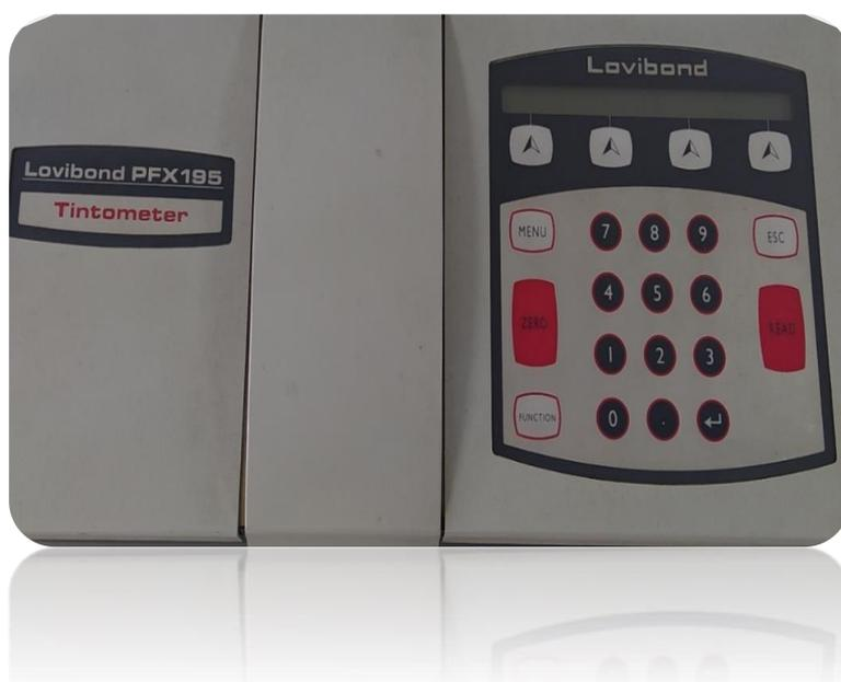
**Photo.III.5.** Appareil colorimètre pour la mesure de la couleur.
