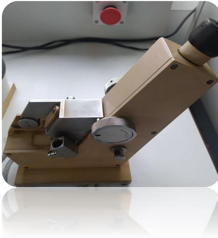
**Photo.III.13.** Appareil utilisé pour déterminer l'indice de réfraction.
