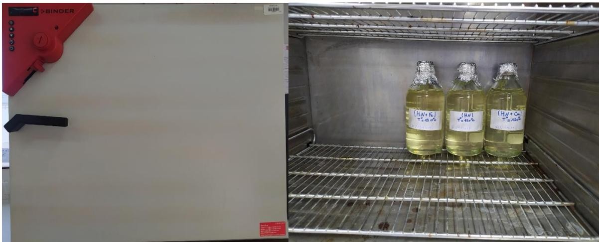
**Photo.III.4.** Les échantillons dans une étuve à 120°C.
