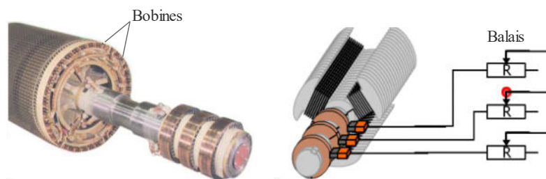
Figure 1.23 : Rotor bobiné d'un MAS
