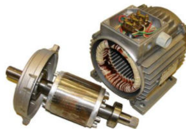
Figure 1.19 : Moteur asynchrone triphasé
