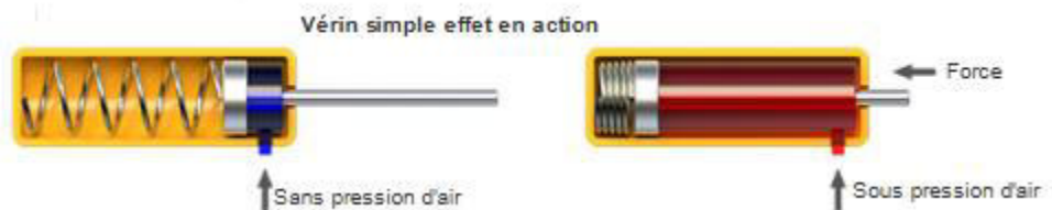
Figure 2.6 : Principe de fonctionnement d'un VSE
