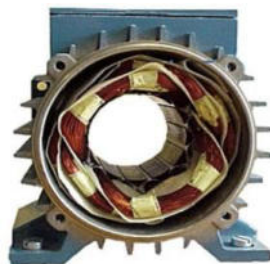
Figure 1.22 : Stator d'un MAS
