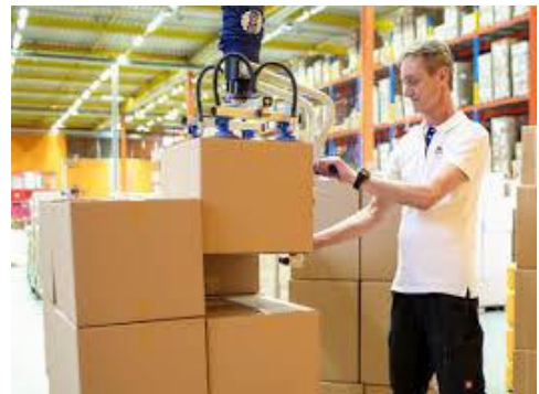
Figure 2.14 : utilisation des ventouses pour le soulèvement de
